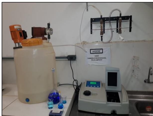
Figura 17 - Sistema de descloração de água de abastecimento obtido da pirólise do sabugo do milho. Fonte: Autor (2018)
