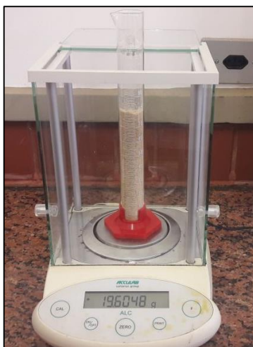
Figura 10 - Densidade aparente do sabugo de milho. Fonte: Autor (2018)
