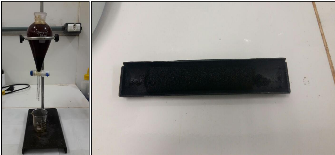
Figura 5 - Bio-óleo e carvão ativado obtido na pirólise do sabugo do milho.
