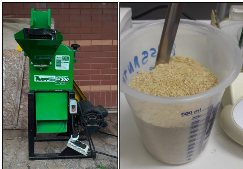
Figura 8 - Triturador e biomassa após peneiração. Fonte: Autor (2018)
