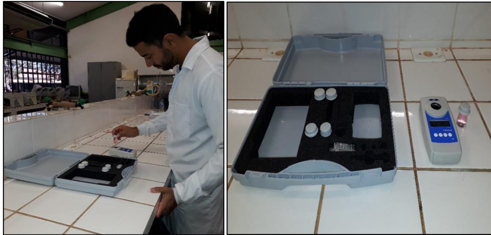
Figura 18 - Ensaios de determinação de cloro presente na amostra Fonte: Autor (2018)
