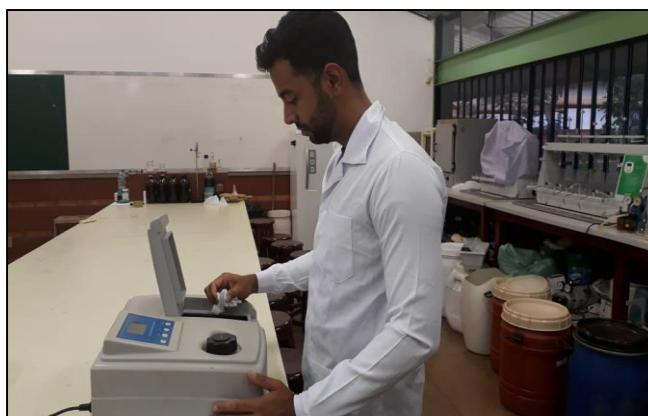
Figura 16 - Análise espectrofotométrica do corante após sistema de filtração. Fonte: Autor (2019)
