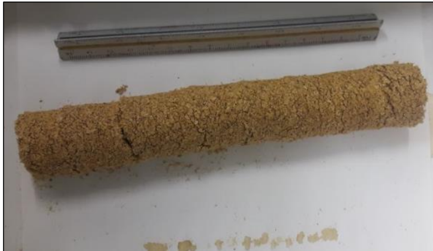
Figura 11 - Briquete obtido do sabugo do milho. Fonte: Autor (2018)
