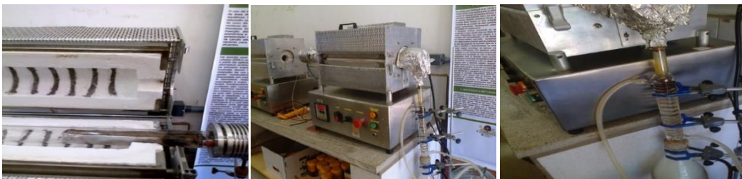
Figura 6 – Reator de pirólise de leito fixo usado para produção de carvão.
