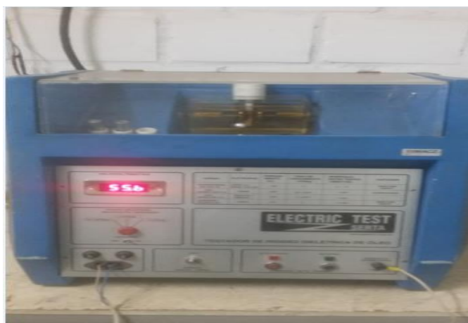
Figura 15 – Aparelho para medição de Rigidez Dielétrica com OMI e OVI
