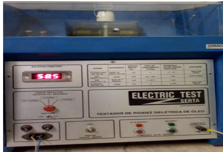
Figura 17 – Primeira medição de Rigidez Dielétrica com OVI
