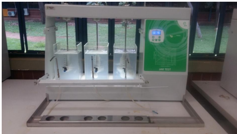
Figura 5.18: Equipamento Jar teste empregado nos ensaios de coagulação/floculação/decantação
