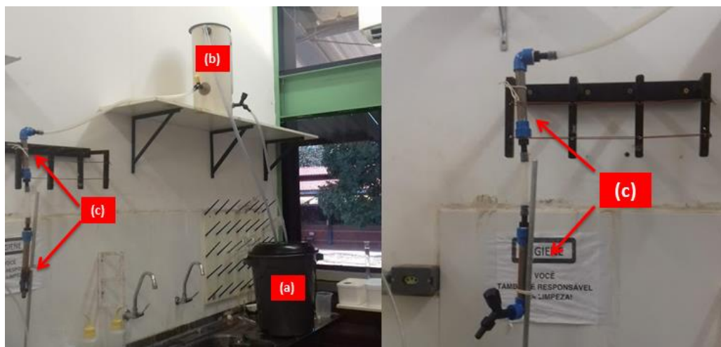
Figura 5.14: Sistema de filtração de corante em carvão obtido da pirólise da casca de arroz.
