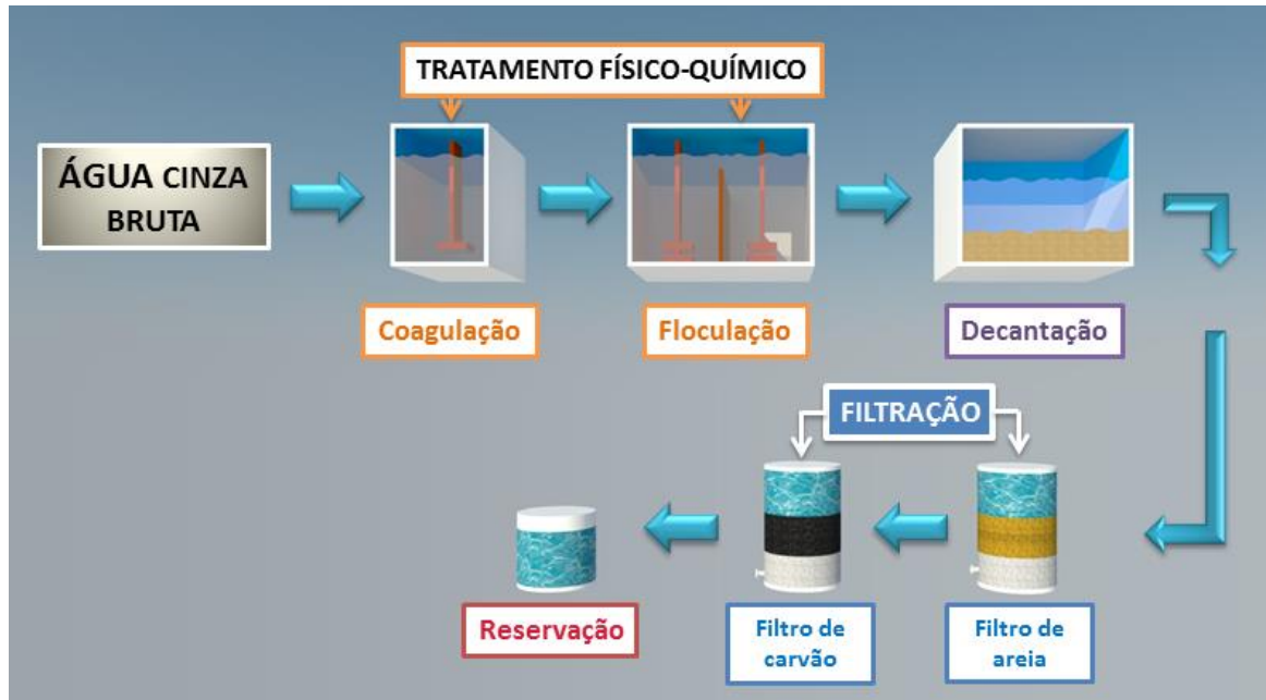
Figura 5.17: Desenho esquemático das etapas do tratamento de águas cinzas.
