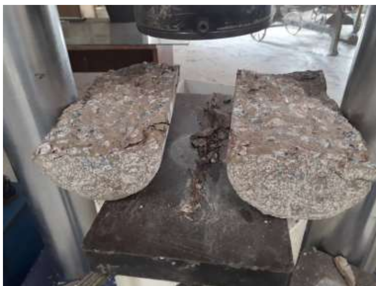
Figura 28: Corpo de prova submetido ao ensaio de compressão diametral
