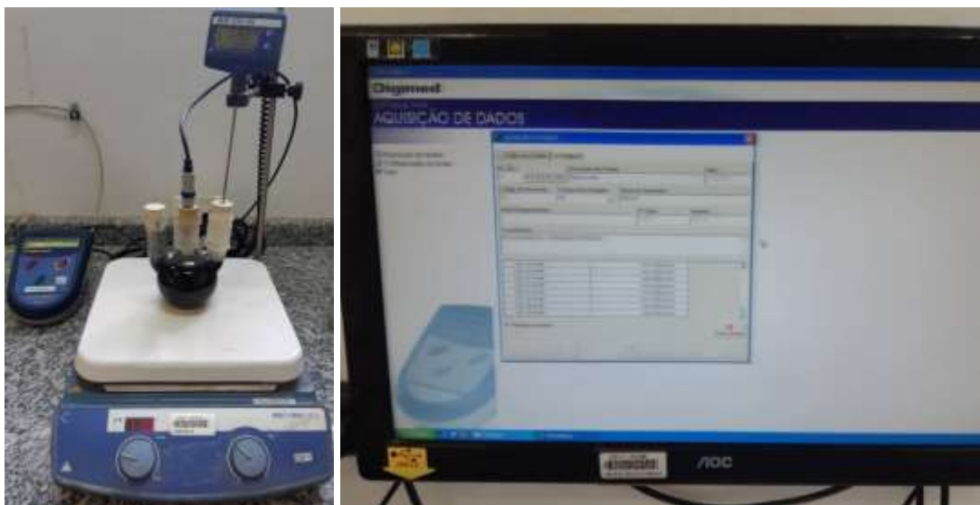
Figura 30: Ensaio de reatividade pozolânica
