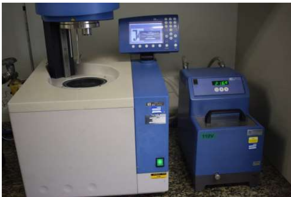
Figura 22: Realização do ensaio em Bomba Calorífica
