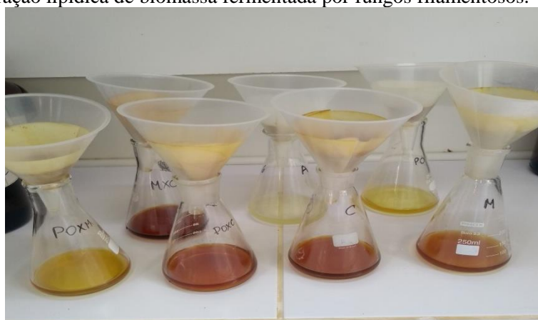
Figura 13. Extração lipídica de biomassa fermentada por fungos filamentosos.
