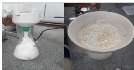
Figura 15. Filtração de amostras para extração de fibra em detergente neutro.
