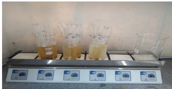
Figura 14. Bloco aquecedor para digestão de fibra em detergente neutro.
