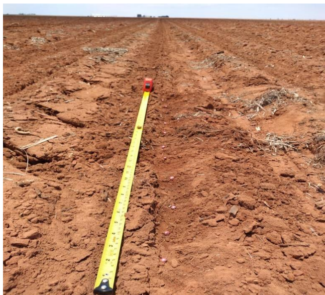
Figura 6: verificação da regulagem, através de contagem de semente.
