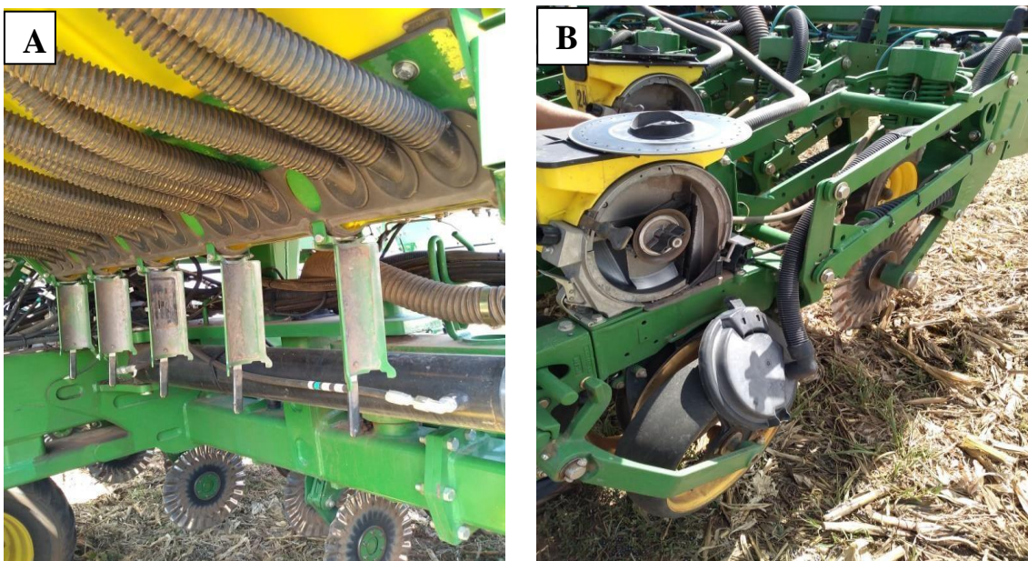
Figura 7: Limpeza das caixas, plantadeira Jhon Deere DB 25 linhas.
