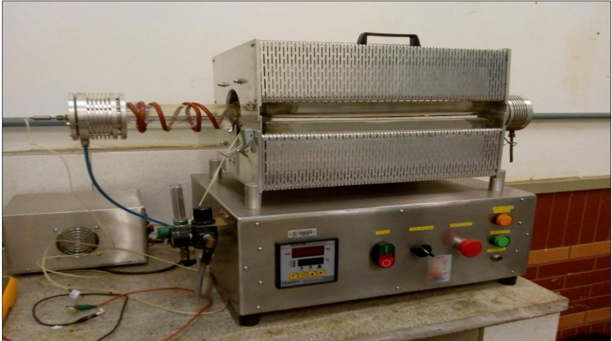
Figura 12. Reator de leito fixo empregado nos experimentos de pirólise de biomassa
