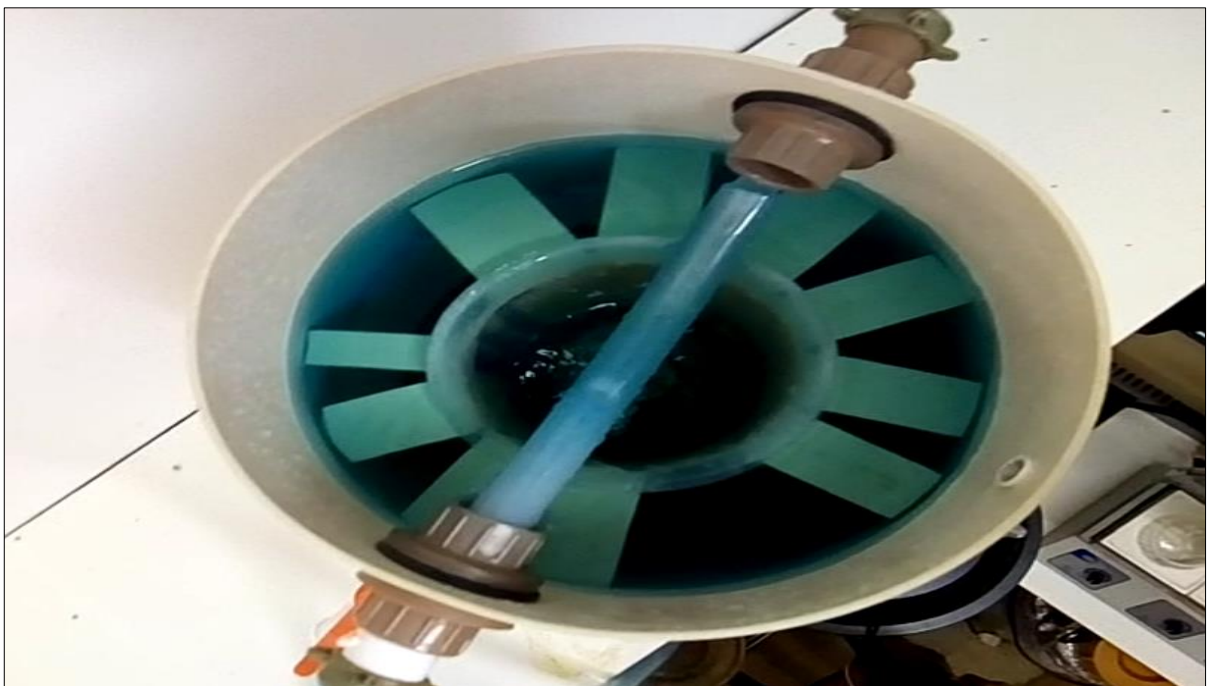
Figura 15. Sistema de filtração de corante em carvão obtido da pirólise de poda de árvores
