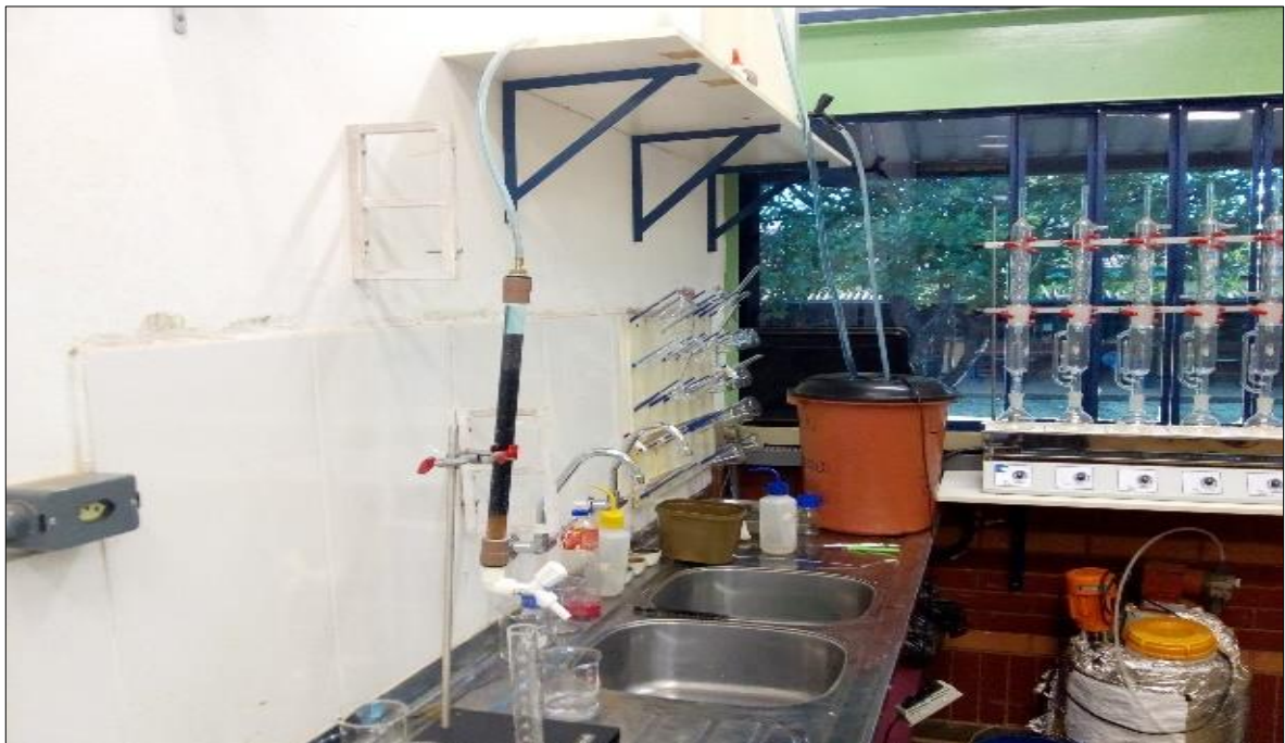
Figura 14. Sistema de filtração de corante em carvão obtido da pirólise de poda de árvores
