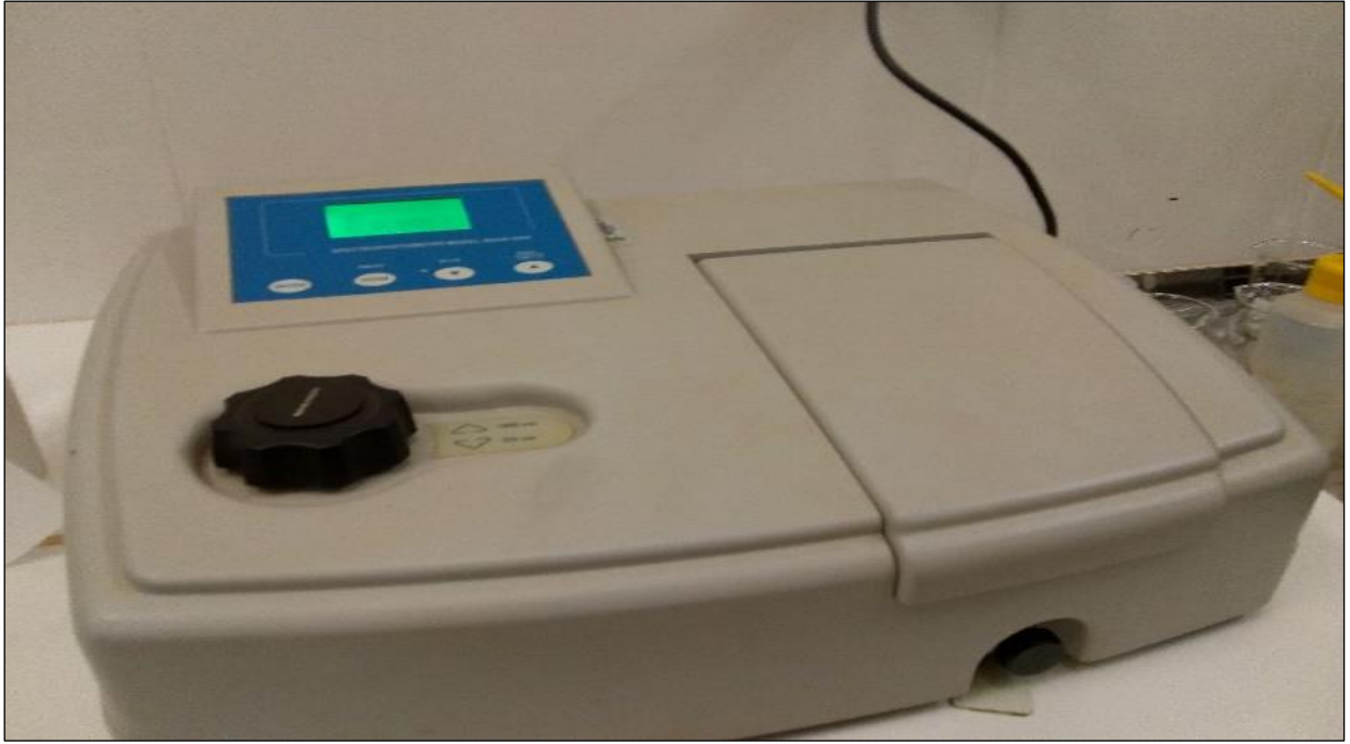
Figura 16. Análise espectrofotométrica do corante após sistema de filtração
