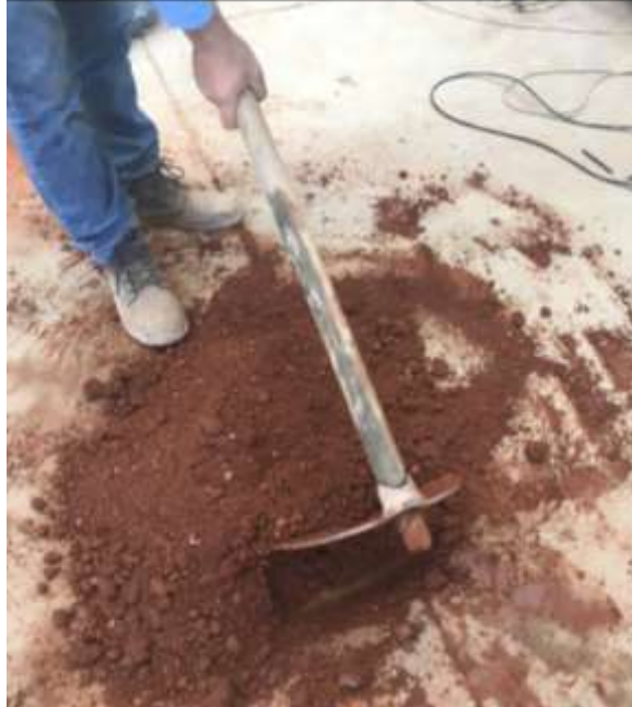
Figura 35- Homogeneização do material de forma manual.
