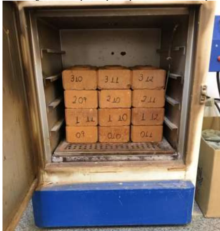
Figura 42- Secagem dos corpos de prova para ensaio de absorção.
