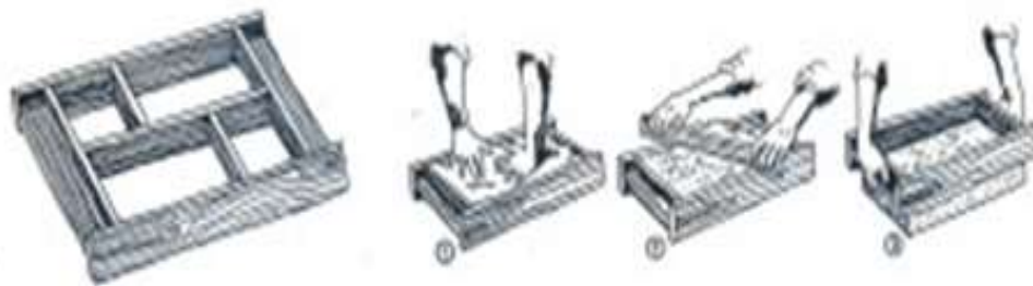
Figura 2 – Moldagem do bloco de adobe.
