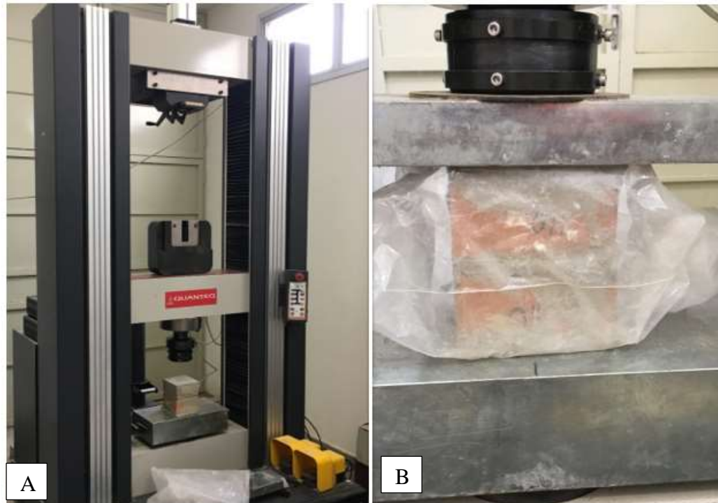
Figura 40- Compressão dos tijolos. A- Prensa utilizada. B- Corpo de prova na prensa.
