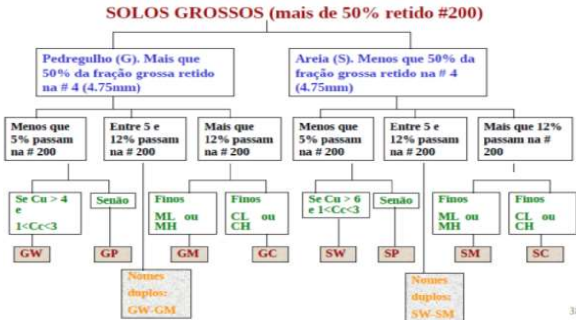
Figura 7- Classificação solos grossos Sistema Unificado Classificação dos solos (SUCS).
