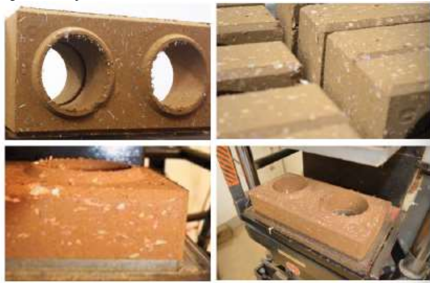
Figura 17- Tijolo solo-cimento fabricado com cédulas de dinheiro.
