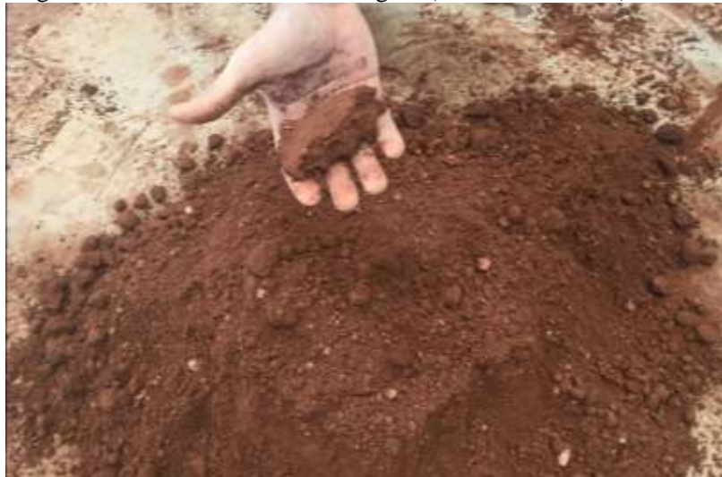
Figura 36 - Consistência de moldagem (teste tátil e visual).
