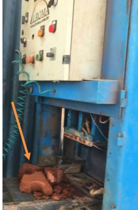
Figura 32- Quebra do tijolo ao retirá-lo da prensa.
