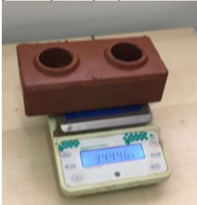
Figura 43- Pesagem dos corpos de provas saturados.
