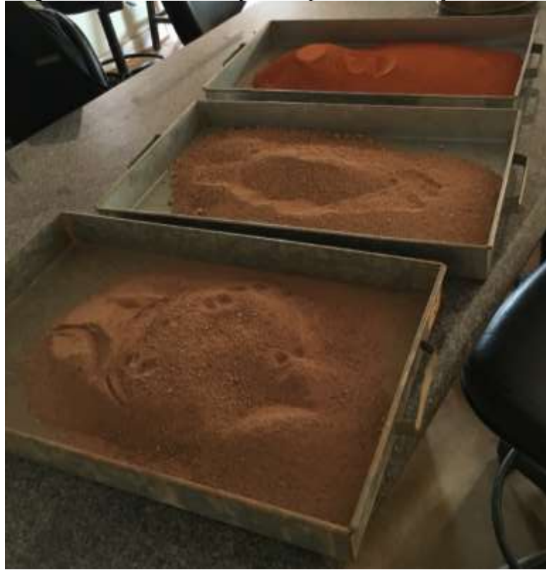
Figura 24- Solos e RCC separados para caracterização.
