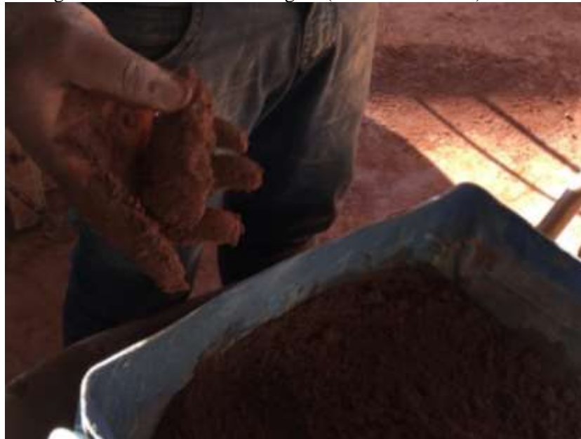
Figura 13- Umidade de moldagem (teste tátil e visual).
