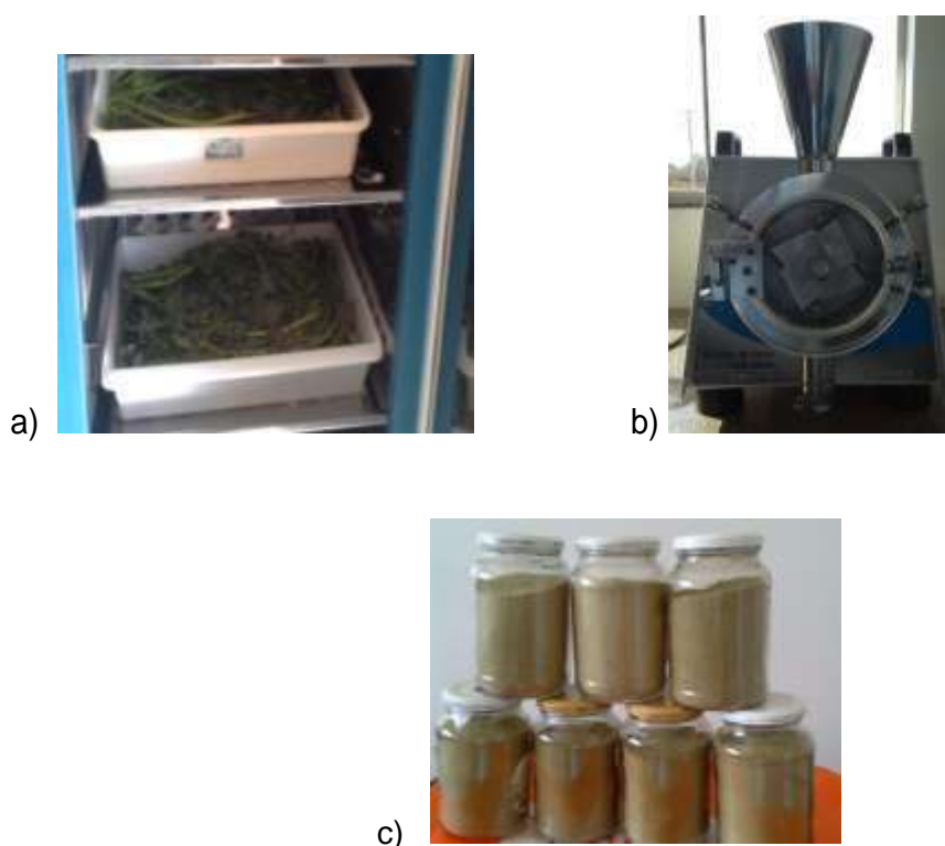
Figura 2a, 2b e 2C - Biomassa de batata-doce seca em estufa (a) e triturada em moinho de facas (b) e armazenados em frascos de vidro (c)
