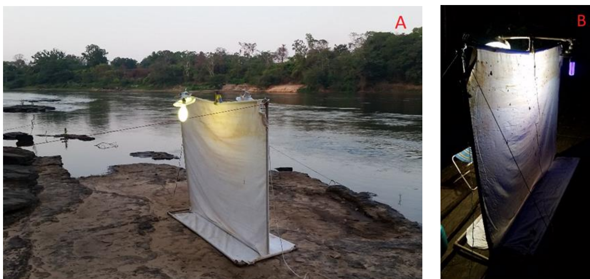
Figura 3 A-B – (A) Lençol iluminado com lâmpadas de mercúrio 250W. (B) combinação de lâmpada de mercúrio e ultravioleta.
