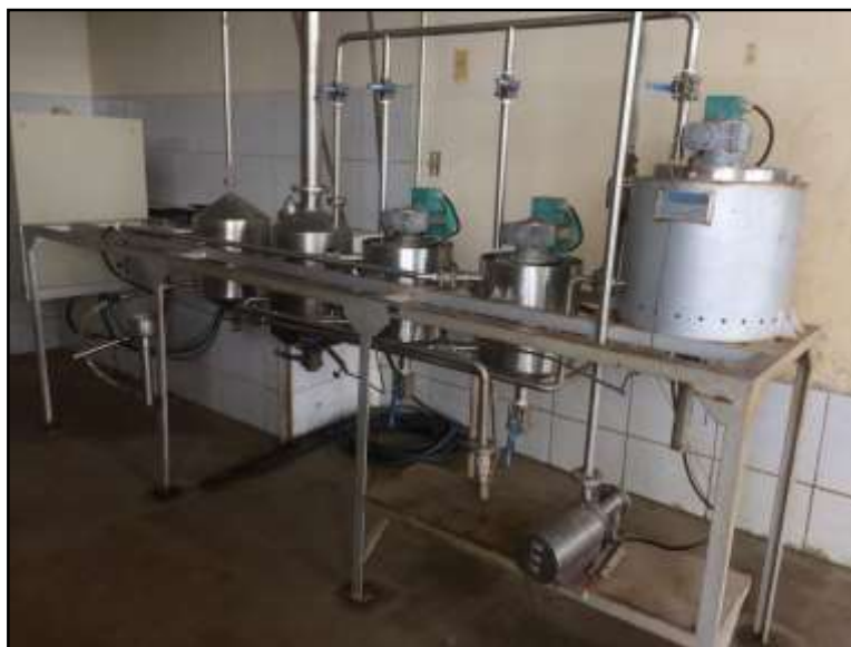
Figura 9 - Micro-usina de processamento automatizado de produção de etanol a partir da batata-doce no LASPER/UFT, Palmas – TO. Fonte: Do autor (2017).
