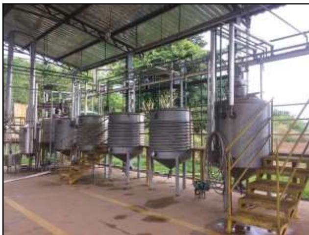
Figura 8 - Usina piloto de processamento automatizado de produção de etanol a partir da batata-doce. LASPER/UFT, Palmas – TO. Fonte: Do autor (2017).
