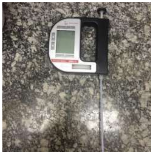
Figura 12 – Densímetro utilizado na análise de densidade. Fonte: LEDBIO.
