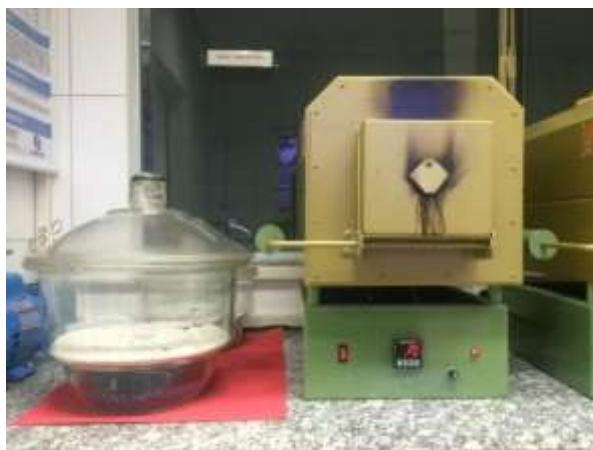
Figura 6 - Mufla utilizada na análise de sólidos voláteis e cinzas. Fonte: LEDBIO.
