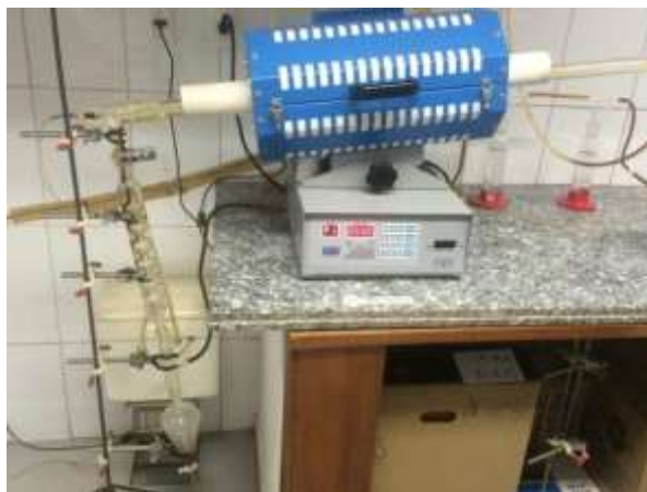
Figura 8 - Reator de pirólise.
