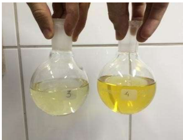
Figura 16 - Extrato e solvente das extrações por Soxhlet do Lodo de Esgoto Digerido. Fonte: LEDBIO.
