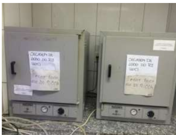
Figura 5 – Estufa utilizada na análise de umidade.
