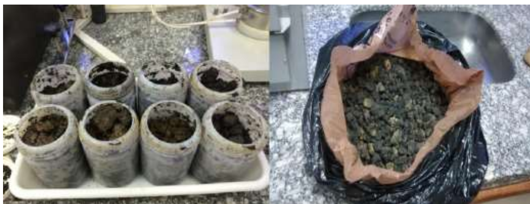
Figura 4 - Lodo de Esgoto Digerido na Triagem.
