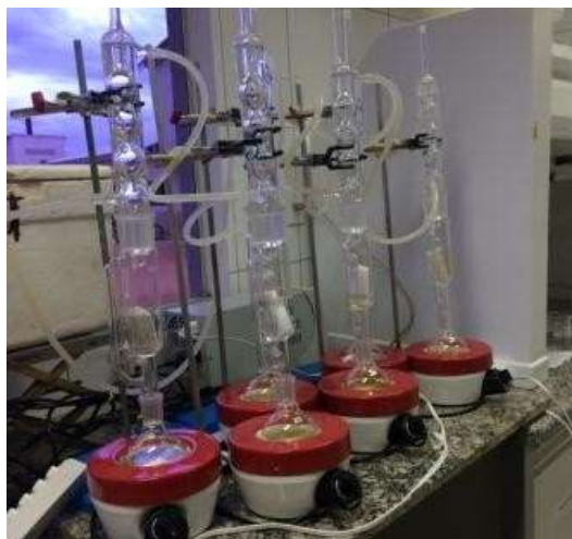
Figura 7 - Extração soxhlet . Fonte: LEDBIO.
