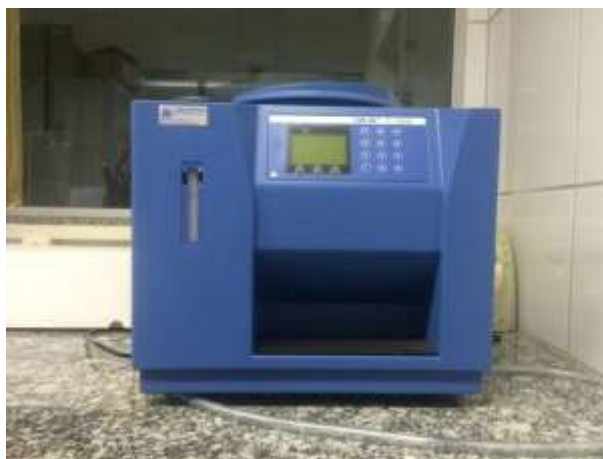
Figura 13 - Calorímetro utilizado na análise do poder calorífico. Fonte: LEDBIO.
