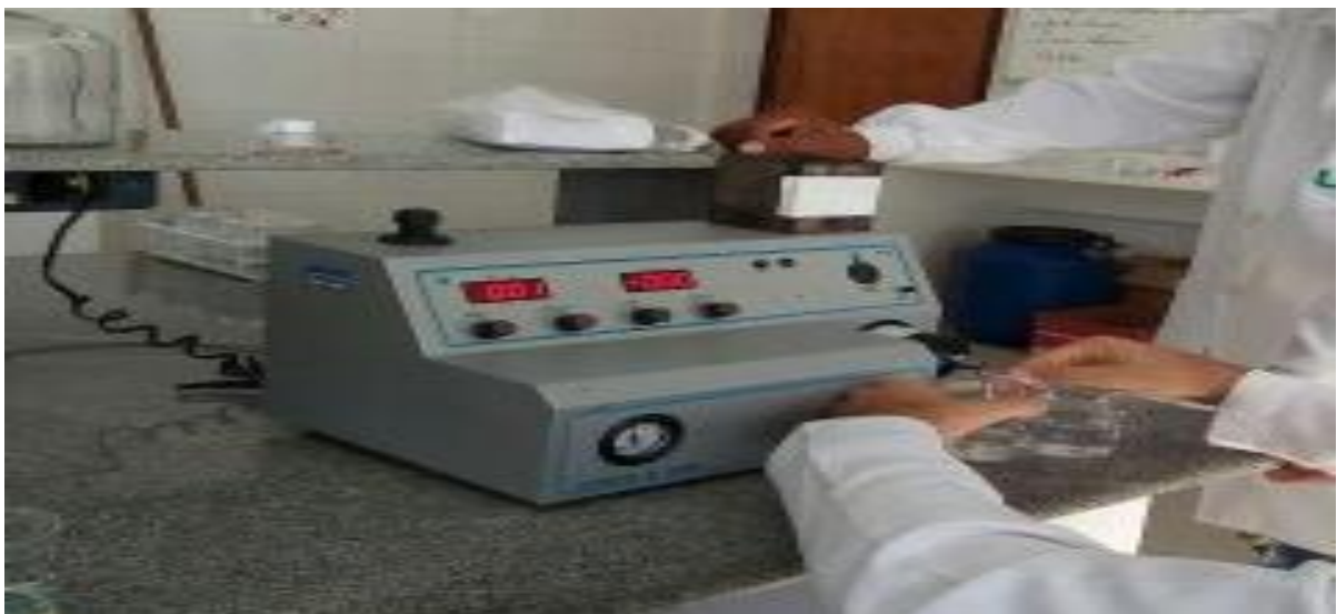
Figura 11 – Análises do biofertilizante (potássio e sódio) em Fotômetro de Chama
