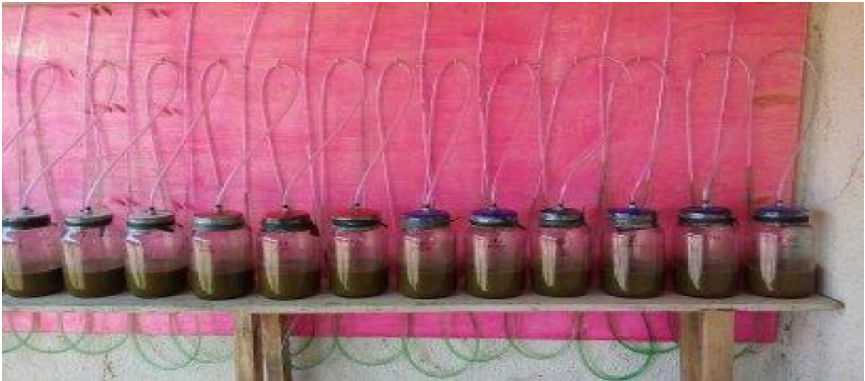
Figura 12- Instalação dos biodigestores com substratos
