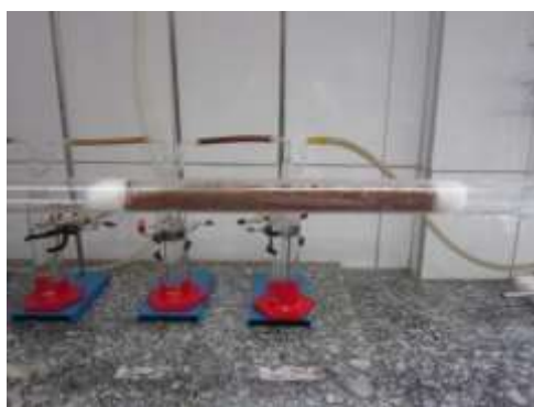
Figura 6 – Tubo reator com a biomassa alojada no centro e isolada por lã de quartzo.
