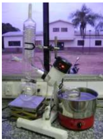
Figura 5 – Rotaevaporador para recuperação do solvente e purificação da fração oleosa.
