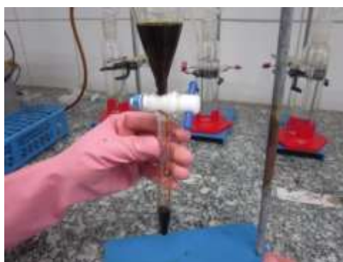
Figura 9 - Separação das frações aquosa e orgânica.
