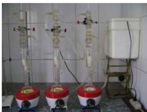
Figura 4 – Extrator do tipo Soxhlet para determinação da fração lipídica da biomassa.
