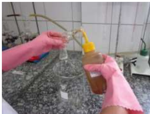
Figura 10 - Lavagem das vidrarias com hexano para recuperação de fração orgânica.
