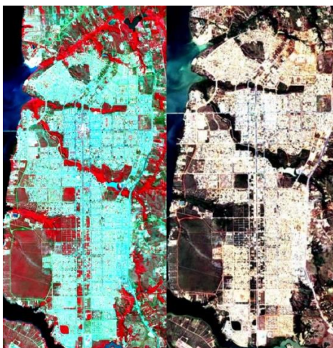
FIGURA 3 IMAGEM COMPARATIVA ENTRE A COMBINAÇÃO DE BANDA FALSA COR B3,B4 E B5(A) E A COR VERDADEIRA (B) REPRESENTATIVA DO PLANO DIRETOR URBANO DE PALMAS
