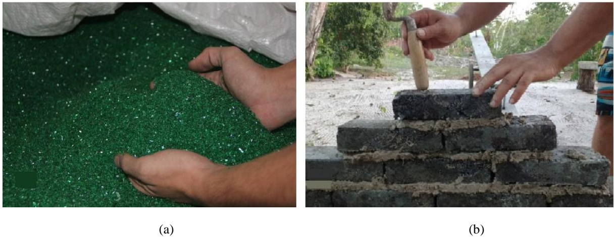
Figura 11- PET triturado para utilização na “creponeira” (a), Tijolo com resíduo de garrafas PET (b)
