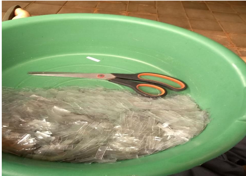
Figura 16- Obtenção do tamanho das fibras
