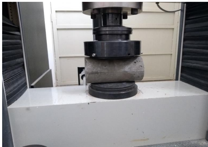
Figura 24 - Ensaio de Tração por compressão diametral
