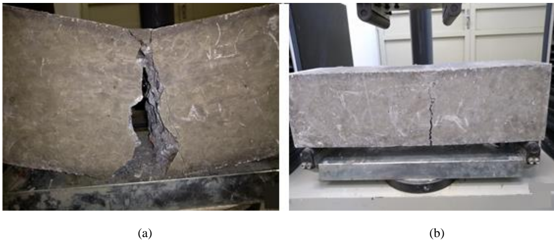
Figura 26- Rupturas apresentadas pelos corpos de prova para as dosagens PET 1 (a) e AÇO (b), no ensaio de Tenacidade
