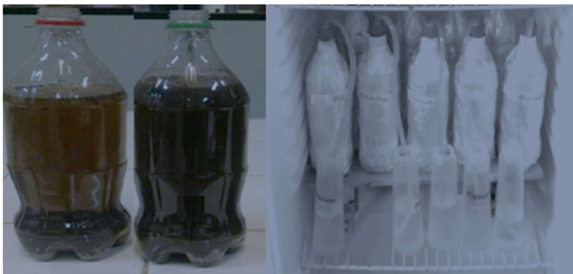
Figura 16 - Experimento para identificar a quantidade de metros cúbicos de biogás/Kg da cama de frango
