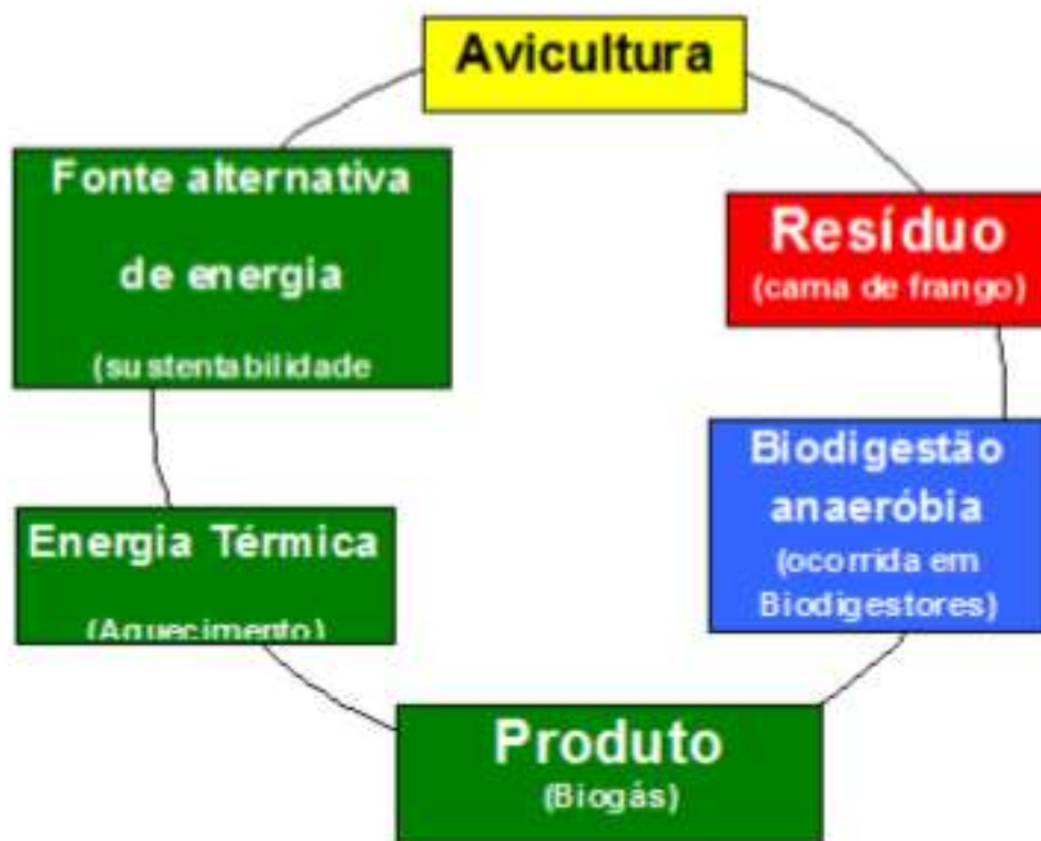
Figura 5 - Ciclo da produção do biogás, a partir da biodigestão anaeróbia da cama de frango.
