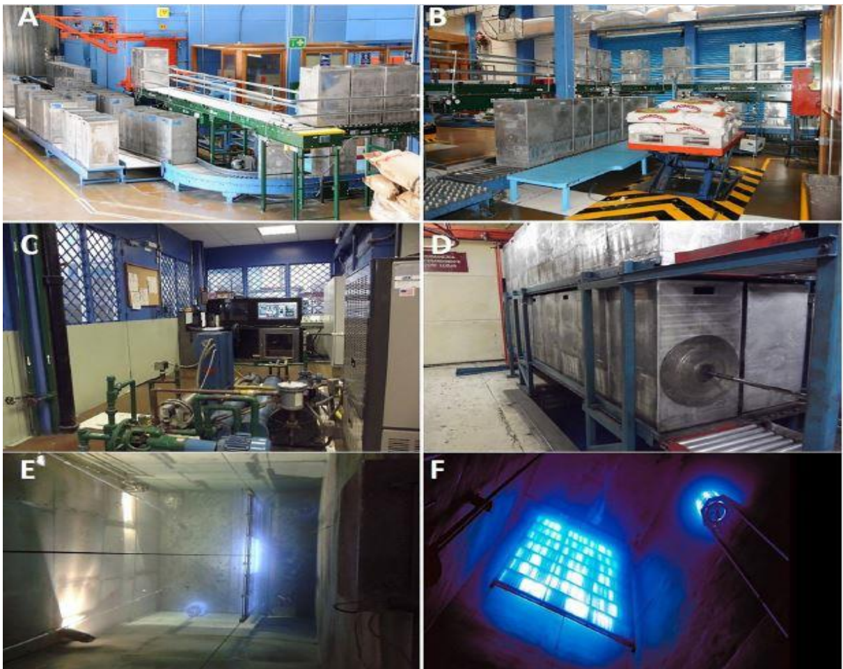
Figura 2: Planta de irradiação ^{60}\text{Co} . (A) visão geral da entrada dos recipientes de produtos na câmara de irradiação (parte superior transportador); (B) mesa hidráulica para paletes de produtos para carregamento de contêineres; (C) sala de controle; (D) visão interna da câmara de irradiação; (E) fonte de ^{60}\text{Co} dentro da piscina de armazenamento; e (F) ^{60}\text{Co} com iluminação. Fonte: Prakash (2019).
