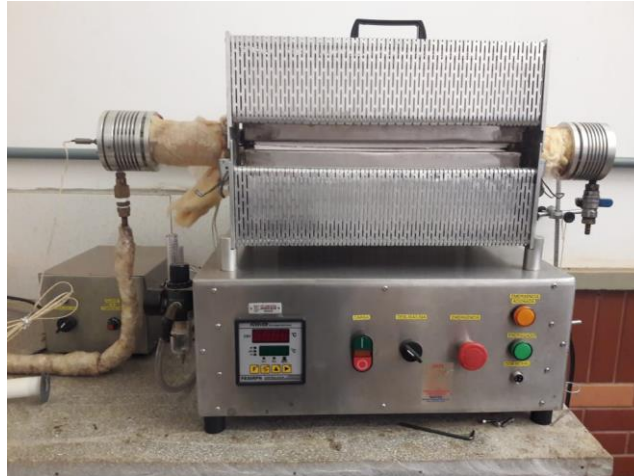
Figura 3 - Reator de leito fixo onde foram realizadas a pirólise
