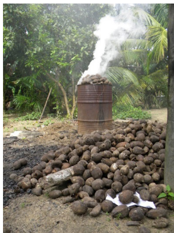
Fotografia 10 – Transformação do coco babaçu em carvão dentro do tambor
