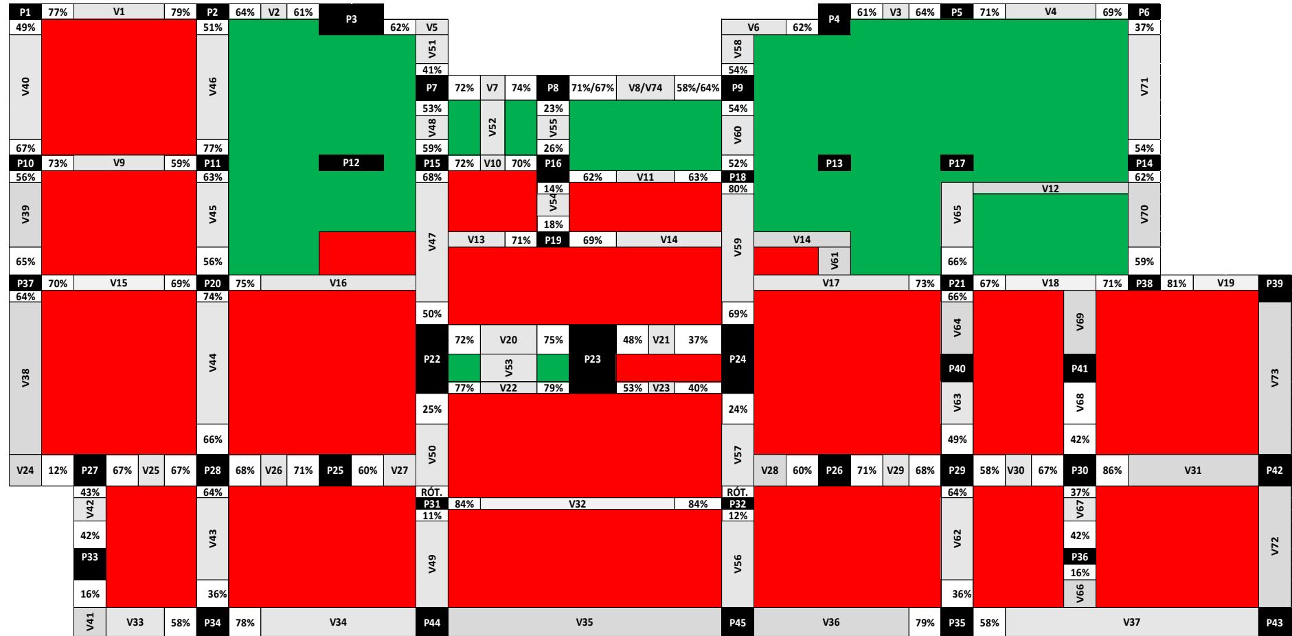
Figura 29 – Fator de engastamento ( \beta ) do pavimento mezanino para a iteração 4
