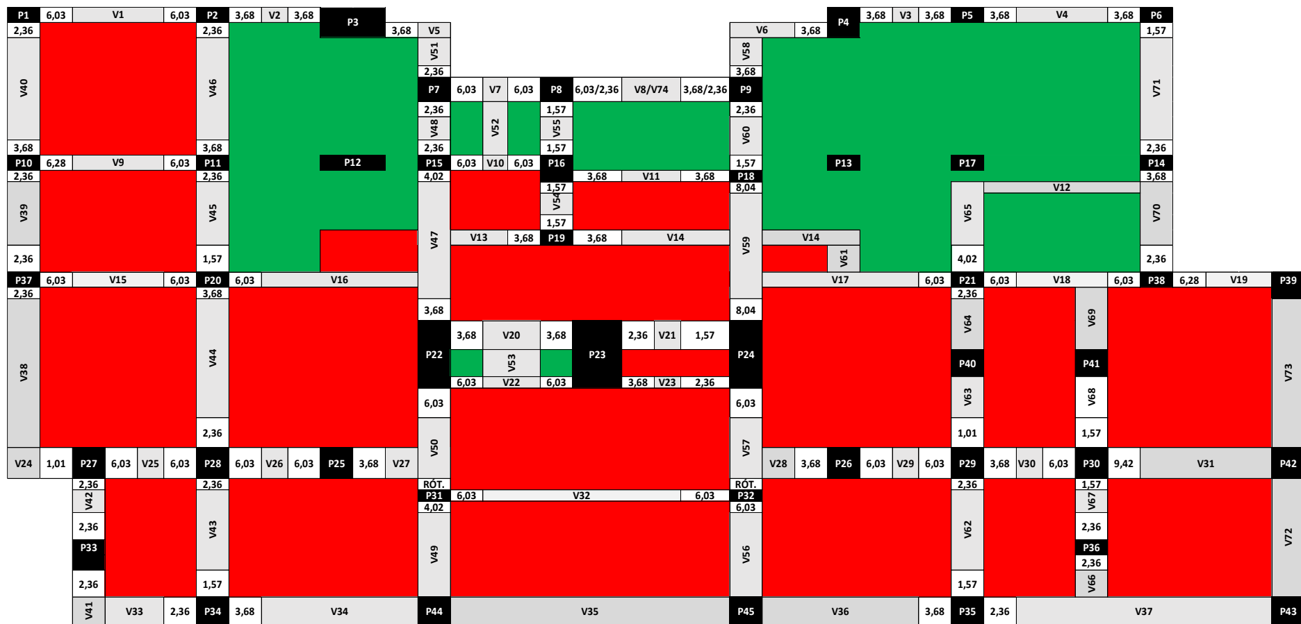
Figura 27 – Área de aço (cm 2 ) do pavimento mezanino para a iteração 4
