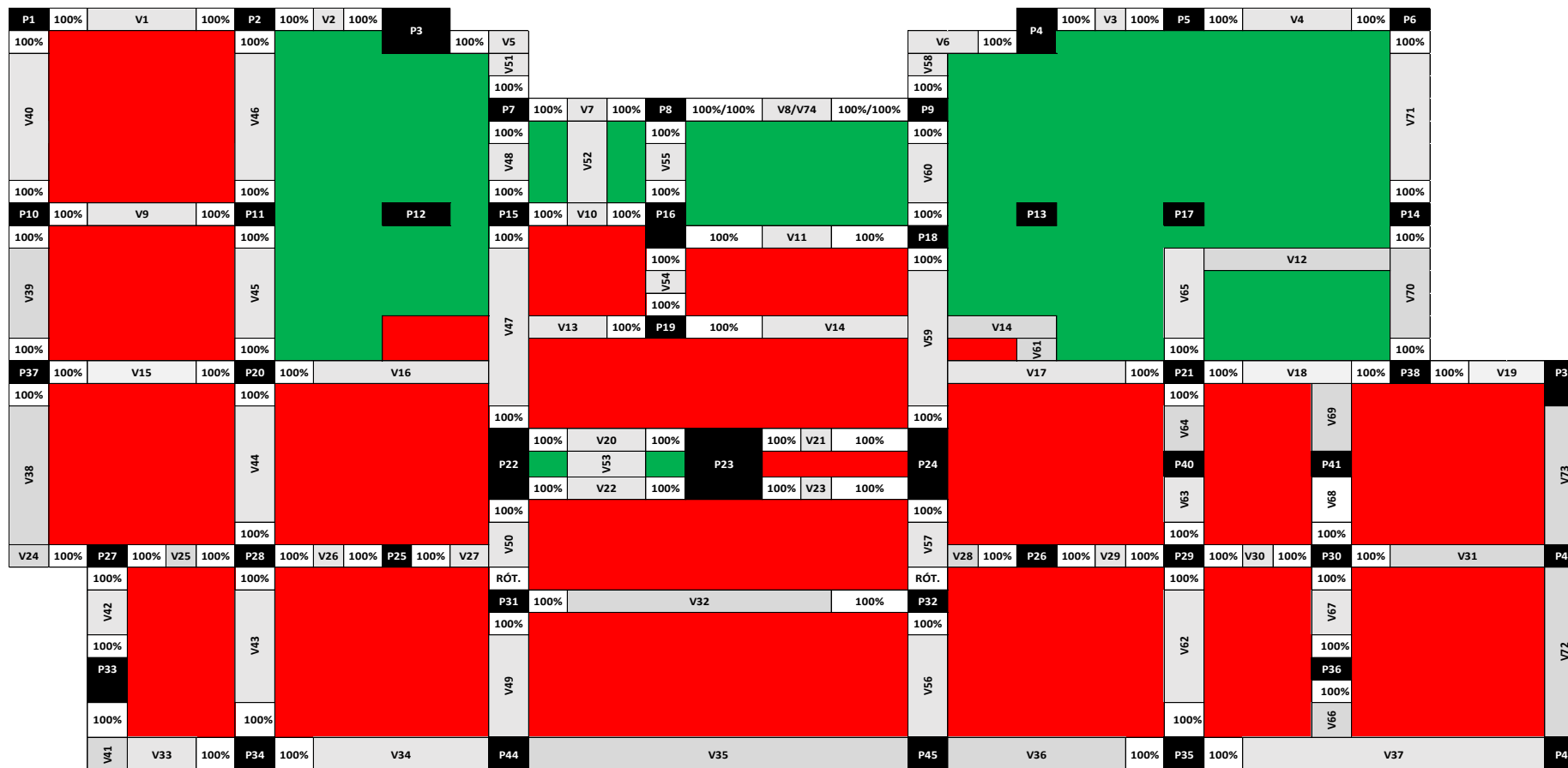
Figura 21 - Fator de engastamento ( \beta ) das ligações do pavimento mezanino
