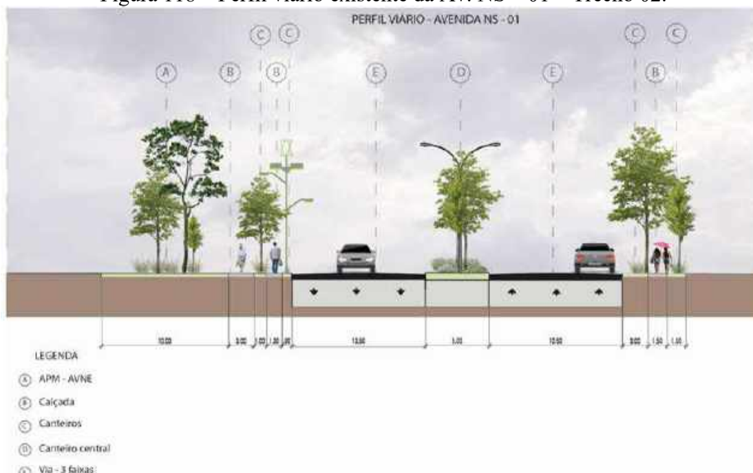
Figura 118 – Perfil viário existente da Av. NS – 01 – Trecho 02.
