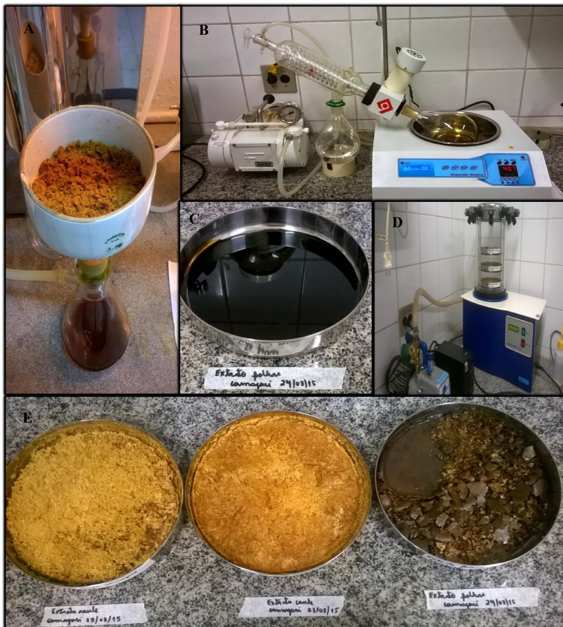
Figura 03 - Preparo dos extratos da casca e das folhas da Terminalia fagifolia : A) Filtragem; B) Retirada do solvente no evaporador rotativo; C) Extrato sem solvente; D) Extratos no liofilizador; E) Extratos liofilizados.
