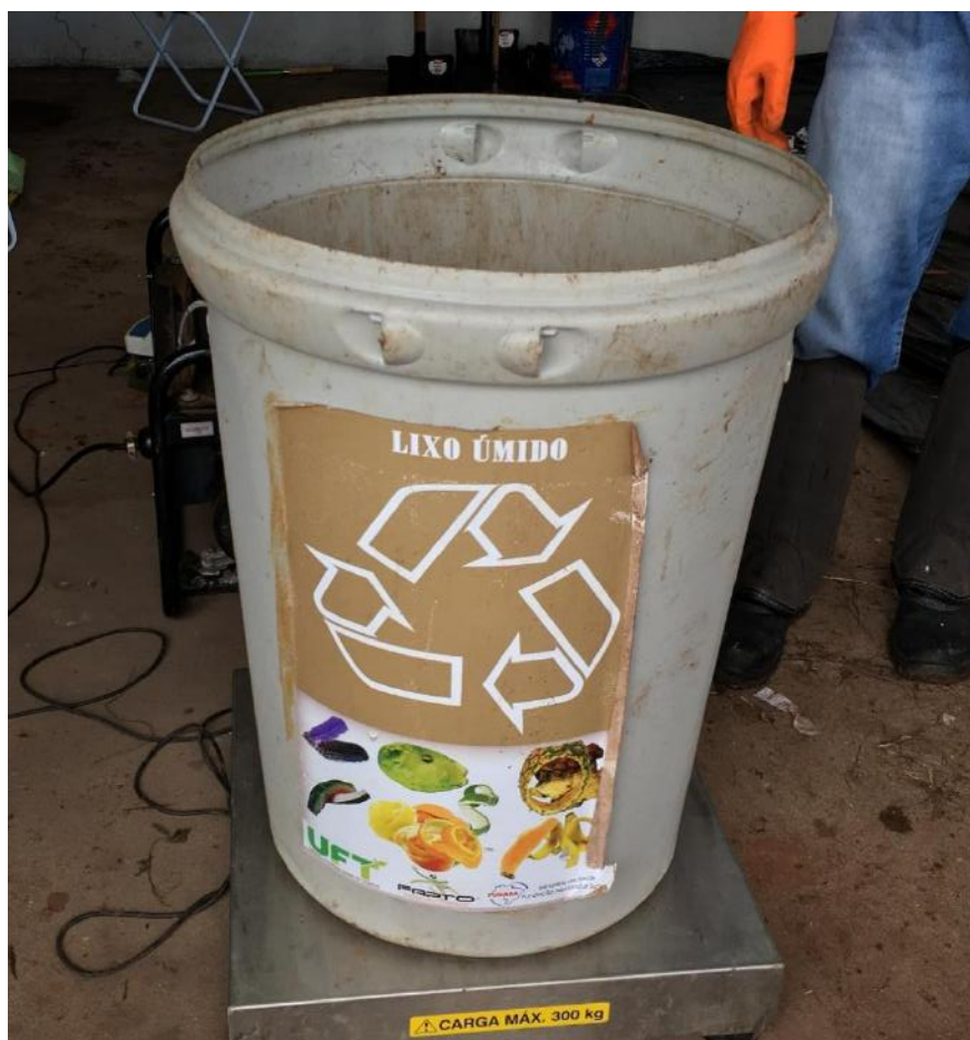
Figura 5 - Pesagem dos materiais segregados no quarteamento dos resíduos sólidos de Darcinópolis/TO.
