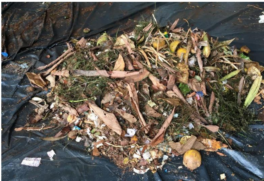
Figura 20 - Quantidade total de matéria orgânica presente na amostra dos resíduos sólidos de Darcinópolis/TO
