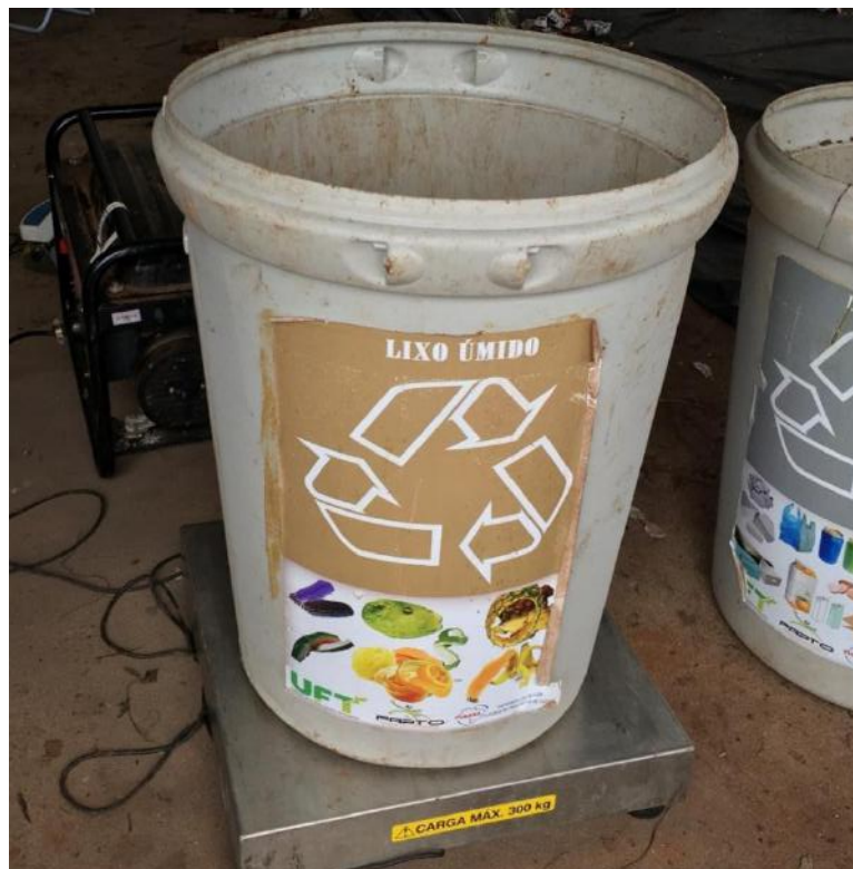
Figura 4 - Tambores utilizados na realização do quarteamento dos resíduos sólidos em Darcinópolis/TO.
