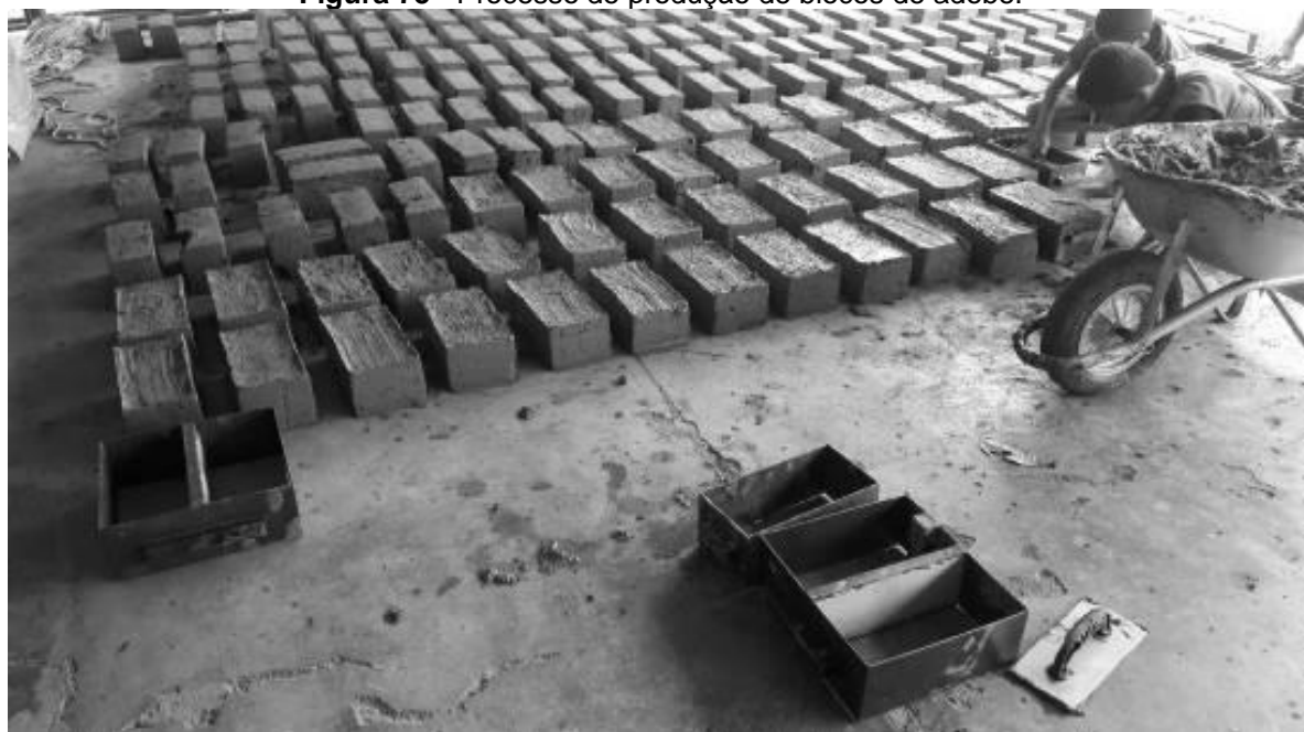
Figura 75 - Processo de produção de blocos de adobe.
