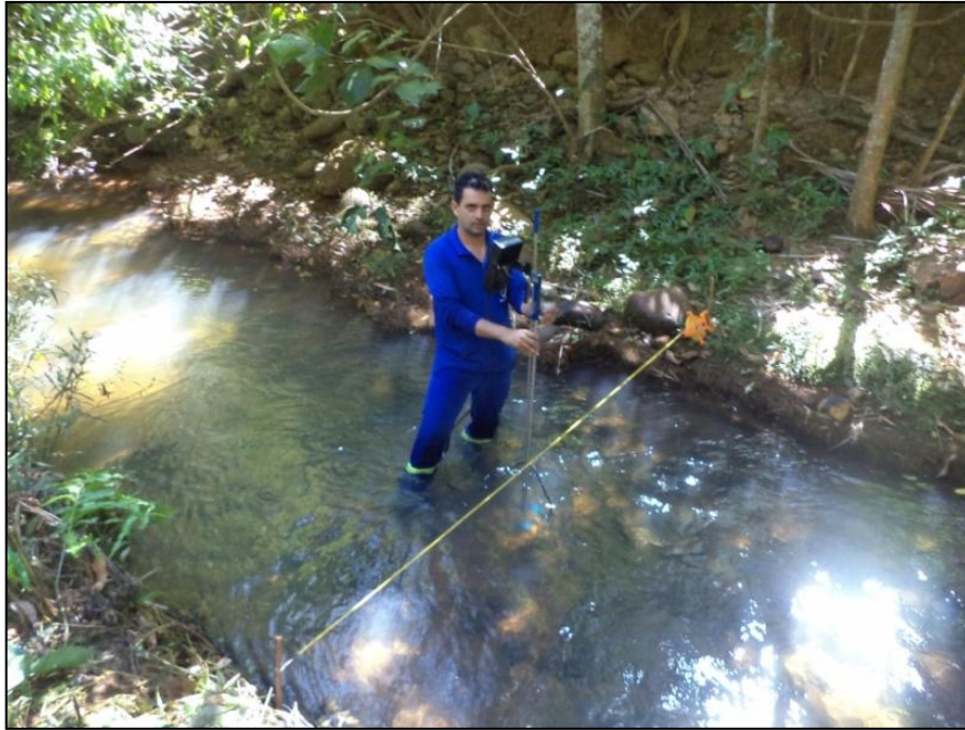
Figura 09 - Validação do método de vazão com o FlowTracker.
