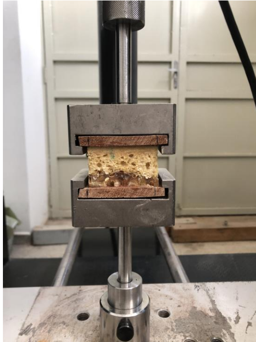
Figura 9 – Corpo de prova posicionado na máquina para ensaio de tração perpendicular.
