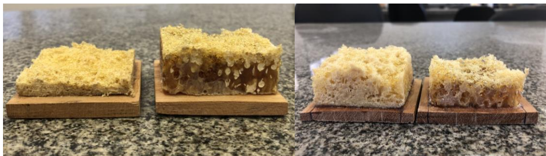
Figura 12 – Corpos de prova após rompimento em ensaio de tração perpendicular (10% e 20%, respectivamente).
