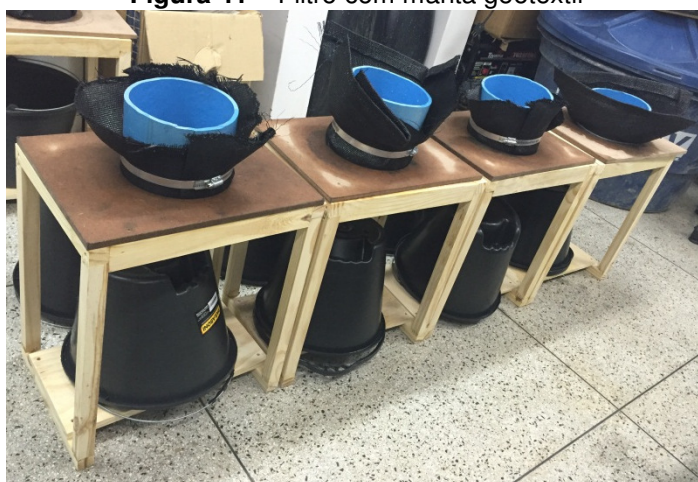
Figura 41 – Filtro com manta geotêxtil
