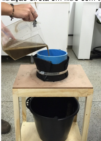
Figura 45 – Filtração direta em filtro com tecido geotêxtil
