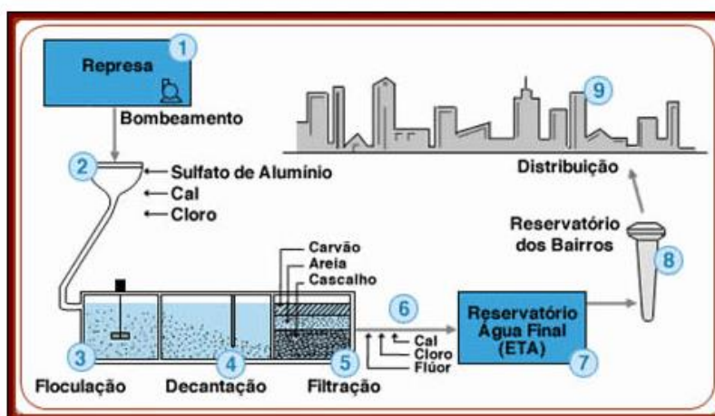
Figura 1: Sistema de abastecimento de água
