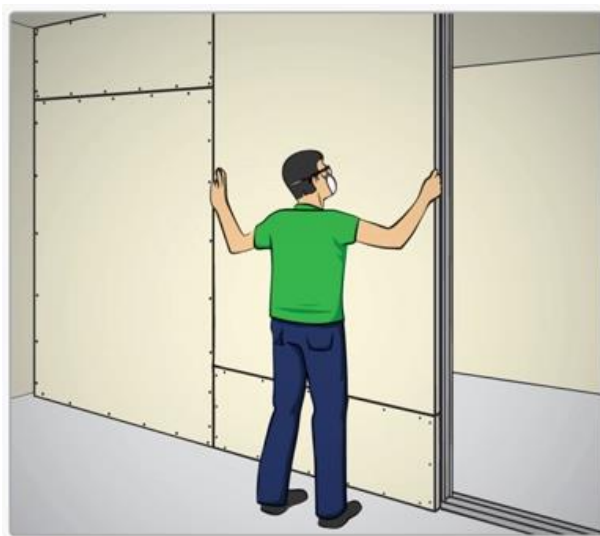
Figura 19 – Instalação das chapas de gesso
