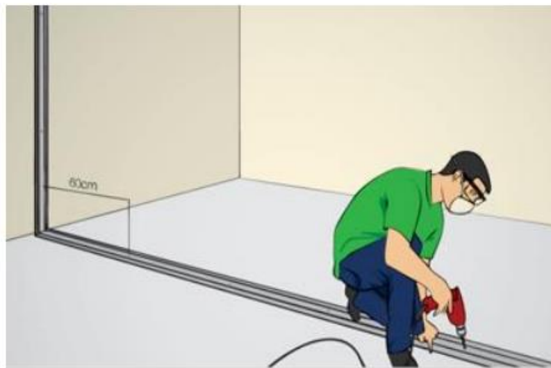
Figura 17 – Fixação das guias
