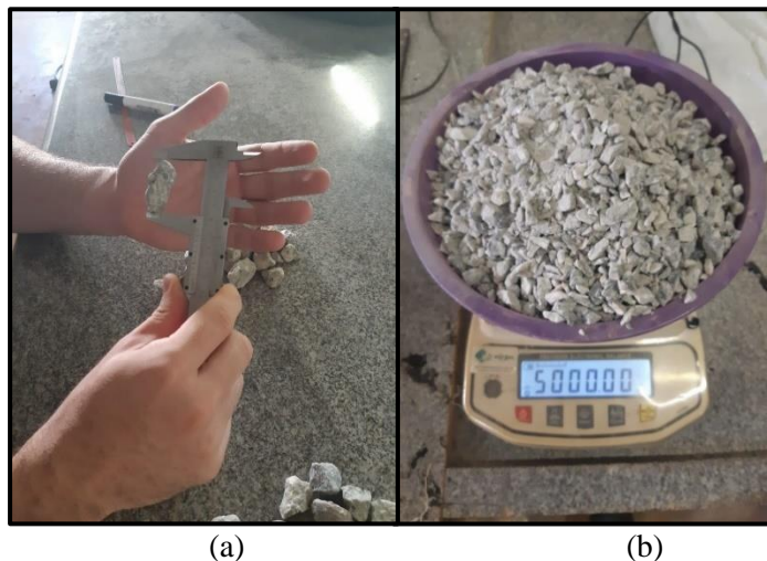
Figura 18 – Aferição de medidas (a) e pesagem das britas (b)
