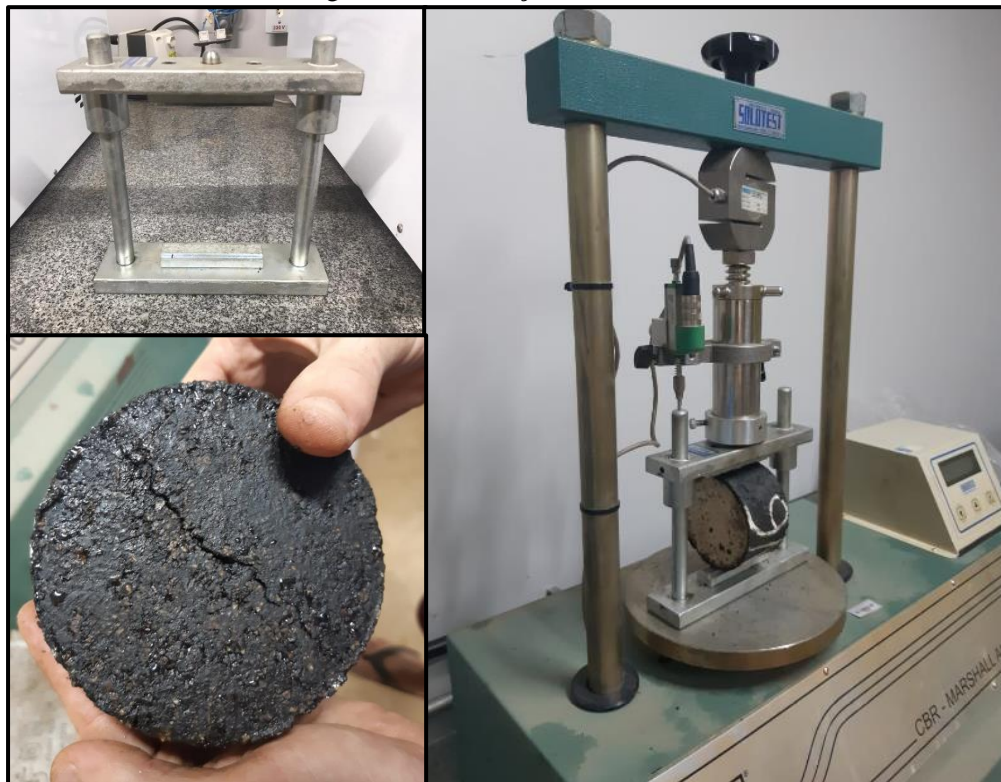
Figura 30 – Execução do ensaio RT
