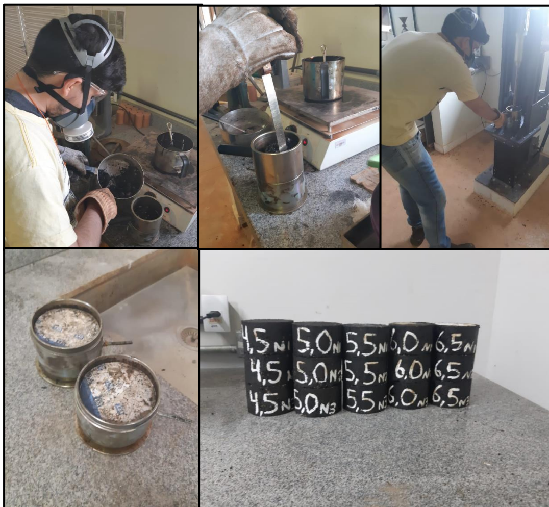
Figura 26 – Compactação dos corpos de prova pela metodologia Marshall
