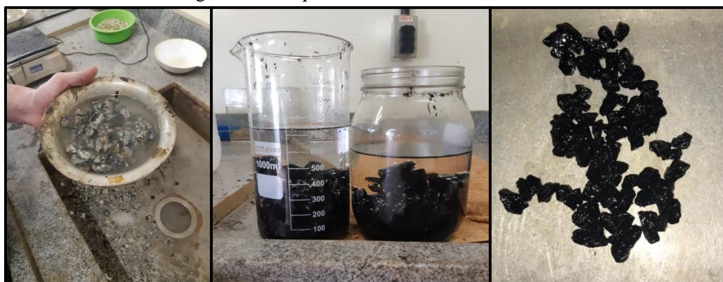
Figura 21 – Esquema do ensaio de adesividade
