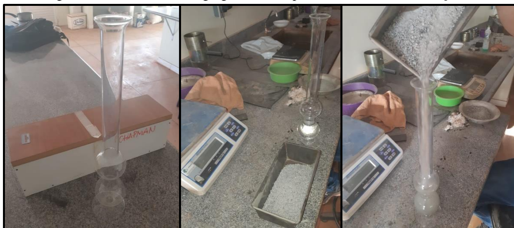
Figura 20 – Densidade do agregado miúdo por meio do frasco de Chapman
