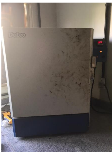
Figura 14: Estufa pré-preparada para compactação.
