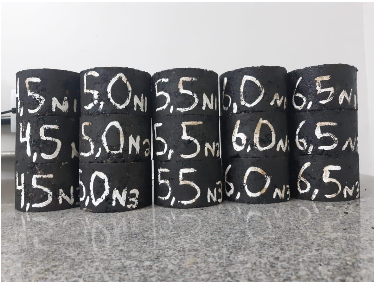
Figura 13: Amostras compactadas iniciais sem fibra.
