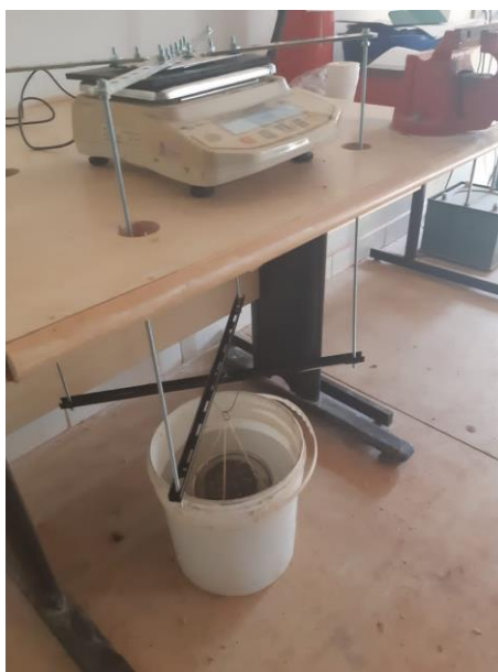
Figura 21: Pesagem submersa de amostra.
