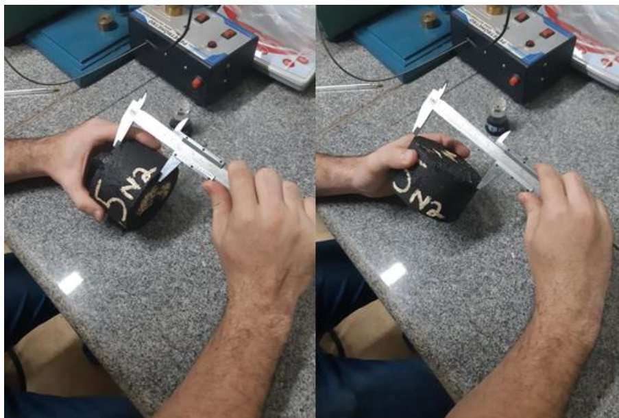
Figura 20: Leitura de altura e diâmetro dos corpos de prova.
