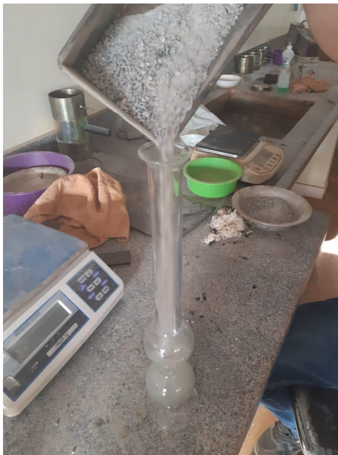
Figura 7: Ensaio de densidade do Pó de Pedra.
