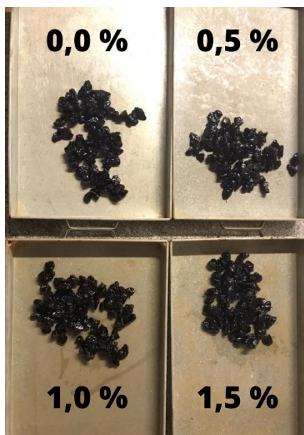
Figura 27: Resultado do ensaio de adesividade conforme teor de fibras.
