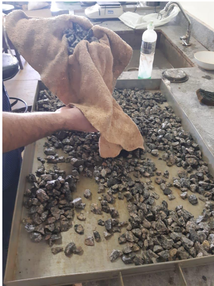
Figura 8: Secagem leve da amostra para pesagem saturada.
