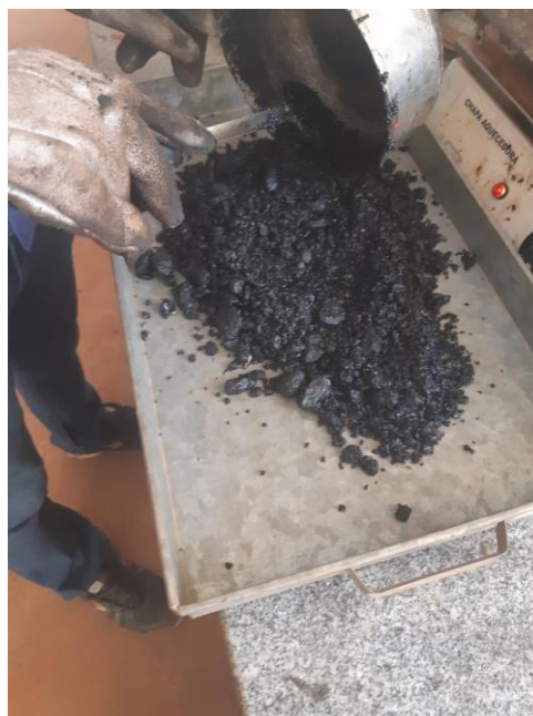
Figura 18: Preparação de amostra não compactada.
