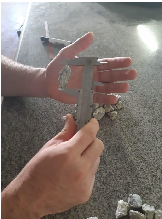
Figura 5: Medição do comprimento da brita.
