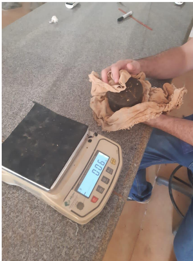
Figura 22: Secagem leve de amostra saturada em sua pré-pesagem.
