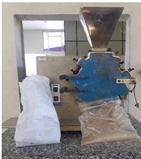
Figura 1 - Moinho de facas do tipo Willey, utilizado na moagem dos resíduos para a fabricação dos painéis
