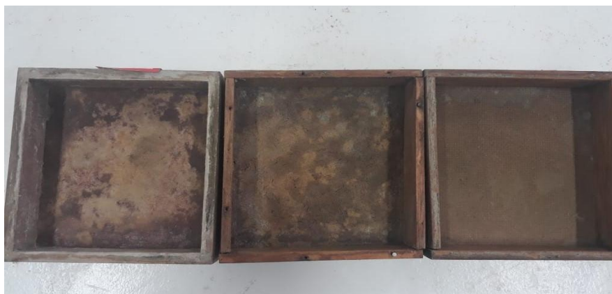
Figura 5 - Moldes prismáticos para confecção dos corpos de prova submetidos aos ensaios de absorção
