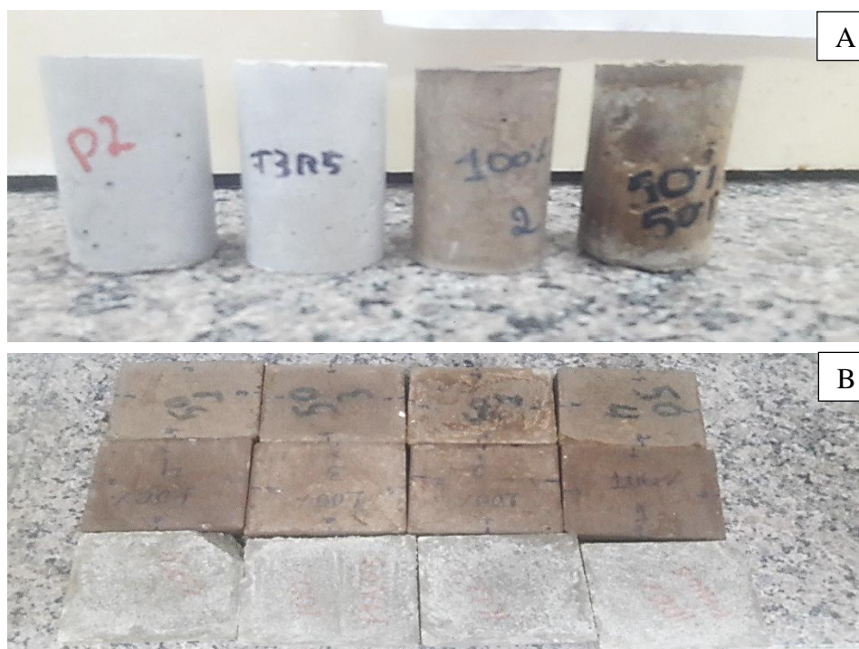
Figura 8 - (A) corpos de prova destinados aos ensaios de compressão axial; (B) corpos de prova destinados aos ensaios de absorção e inchamento, ambos em processo de cura
