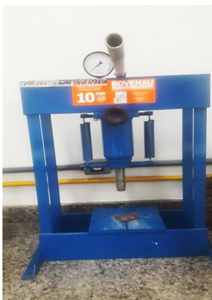
Figura 9 - Prensa hidráulica manual, utilizadas no ensaio de compressão axial dos corpos de prova cilíndricos para determinar a resistência dos mesmos
