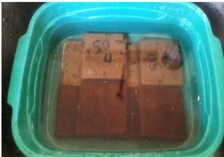
Figura 10 - Corpos de prova submetidos a ensaio de absorção
