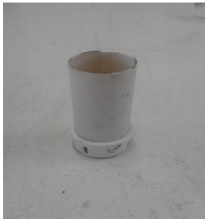
Figura 4 - Moldes cilíndricos confeccionados para fabricação dos corpos de prova submetidos ao ensaio de compressão axial
