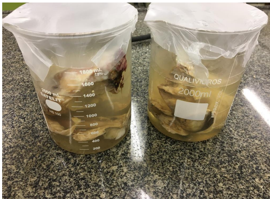
Figura 6- Cortes da cabeça do pirarucu imergidas no pré-tratamento em ácido acético a 4,5 %.
