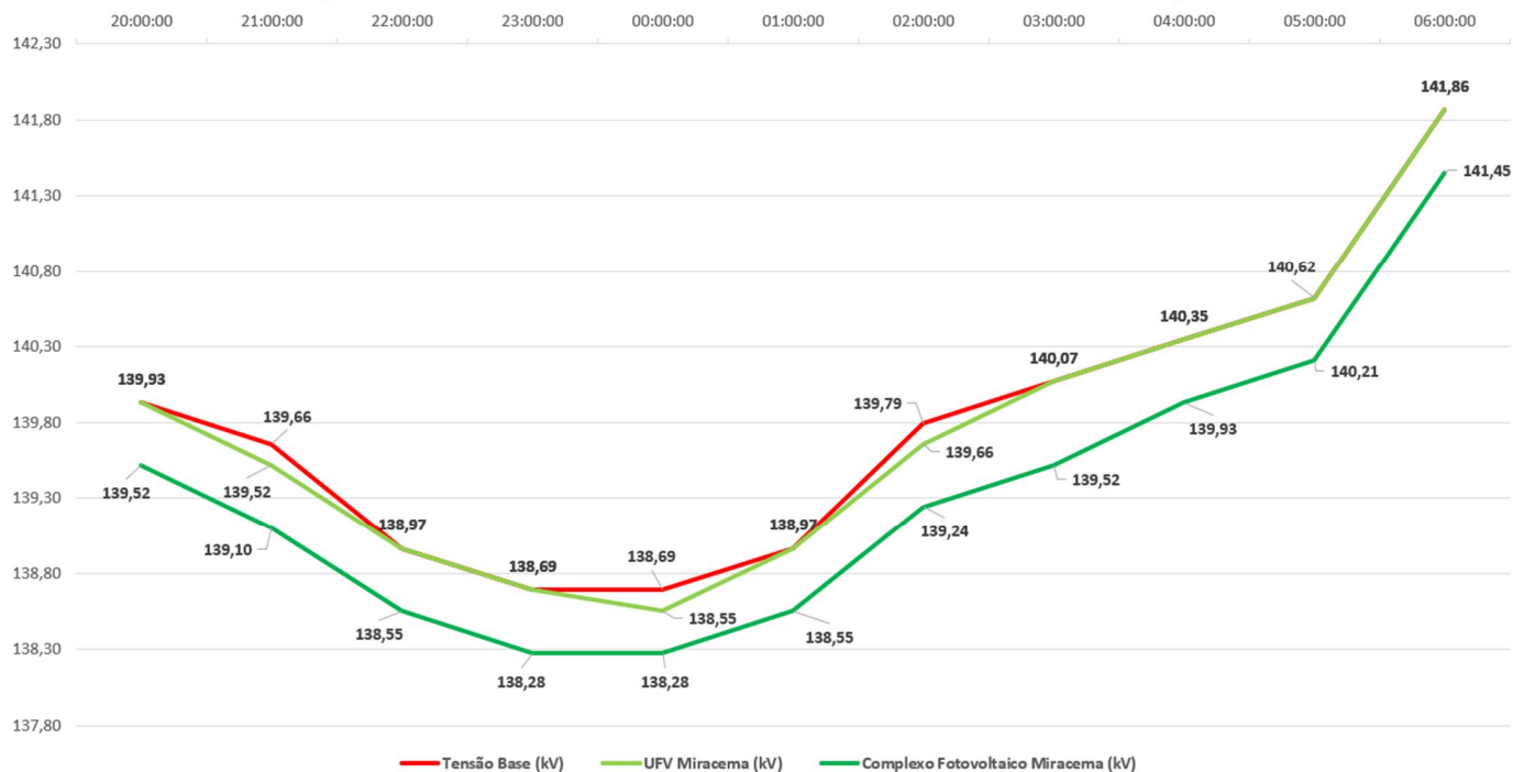
Figura 31 – Controle da Tensão no Barramento Paraíso 2 138 kV – Domingo.
