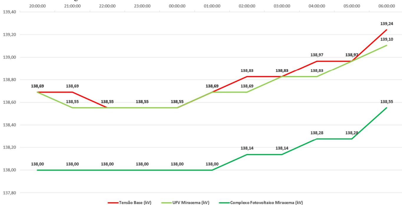
Figura 25 – Controle da Tensão no Barramento da UFV Miracema 138 kV – Sábado.
