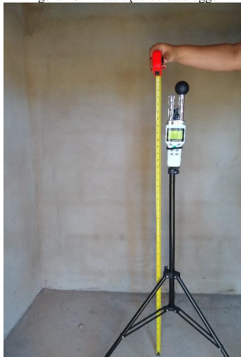
Figura 16 – Instalação do datalogger
