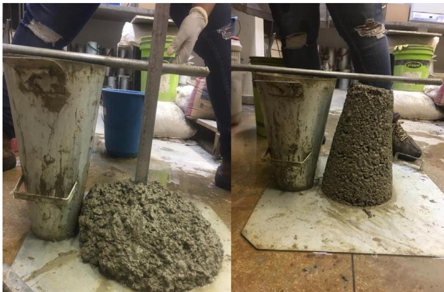
Figura 14– Ensaio de abatimento do tronco de cone no traços TR25 e TR100
