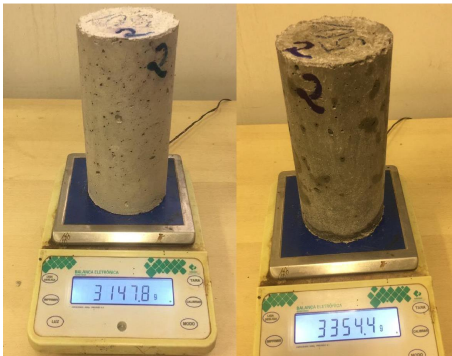
Figura 19 – Pesagem dos corpos de prova em estado seco e saturado
