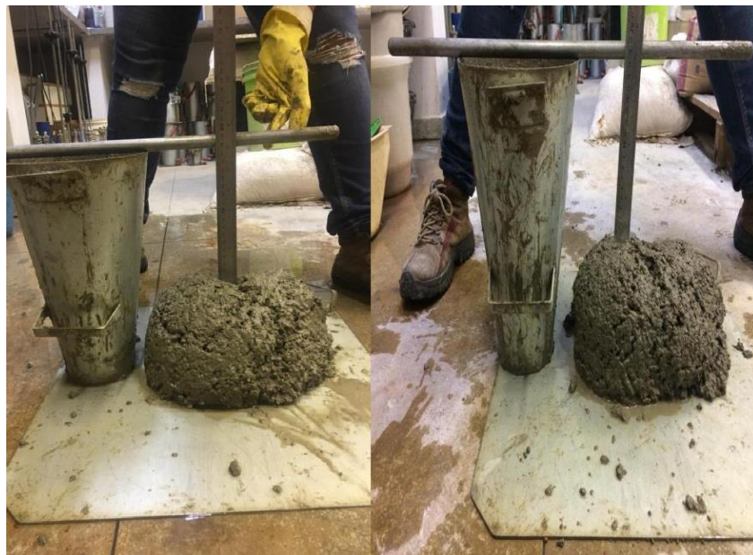
Figura 24 - Ensaio de abatimento do tronco do cone nos traços TR50 e TR75
