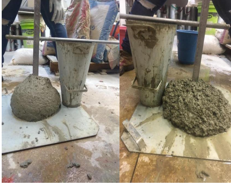
Figura 23 - Ensaio de abatimento do tronco do cone nos traços TR0 e TR25
