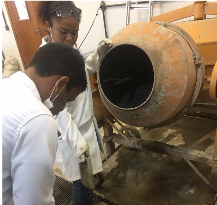
Figura 15 – Processo de mistura dos componentes do concreto
