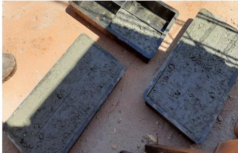
Figura 19: Moldagem dos blocos de referência
