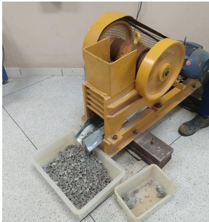
Figura 8: Britador de mandíbula do Laboratório da ULBRA
