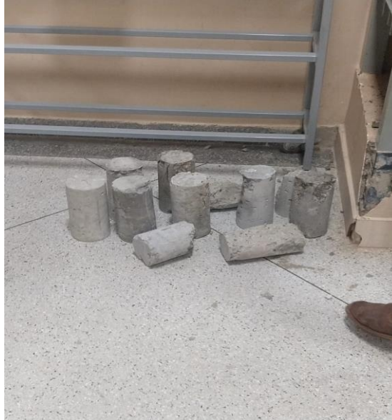
Figura 7: Corpos de prova utilizados na britagem
