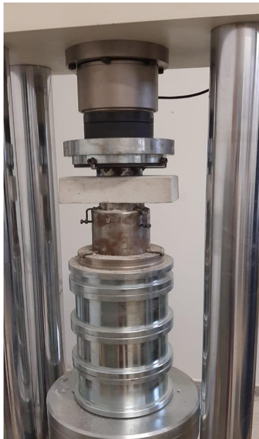
Figura 22: Prensa QUANTEC com placas auxiliares de 85 mm de diâmetro para ensaio de resistência à compressão
