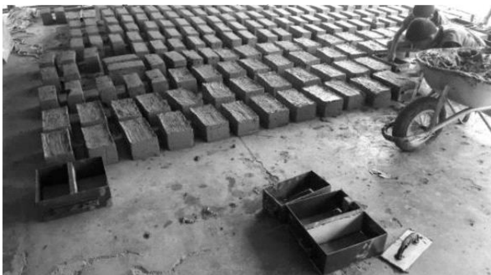
Figura 93 - Produção de tijolos de Adobe no distrito de Taquaruçu
