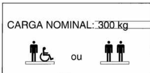
Figura 21 – Imagem representativa da carga nominal para uso da plataforma
