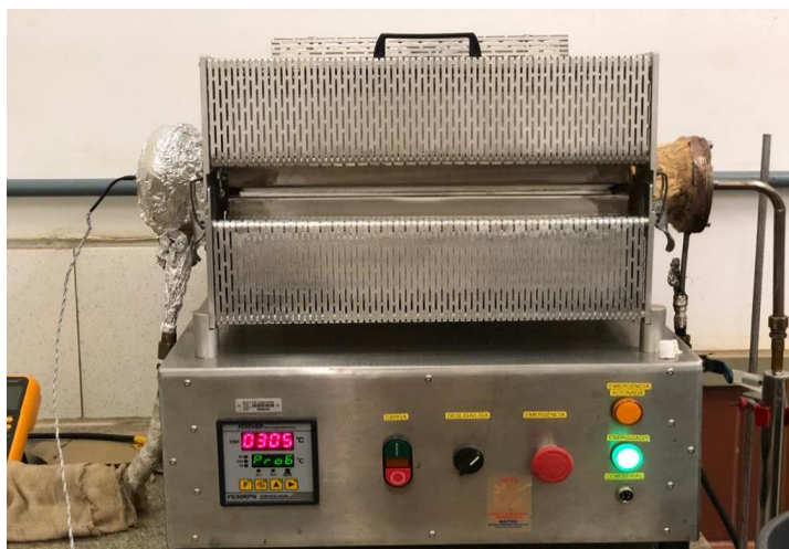
Figura 5: Reator utilizado no processo de pirólise.
