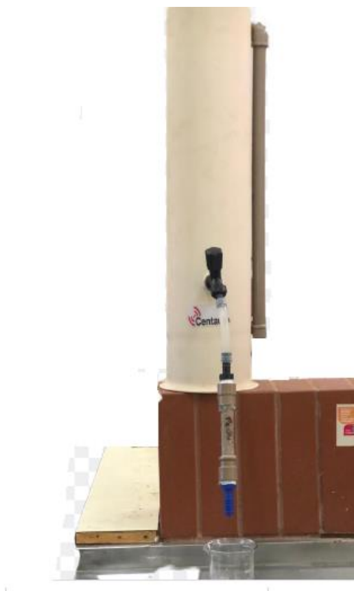
Figura 8: Sistema de adsorção em coluna de leito fixo.
