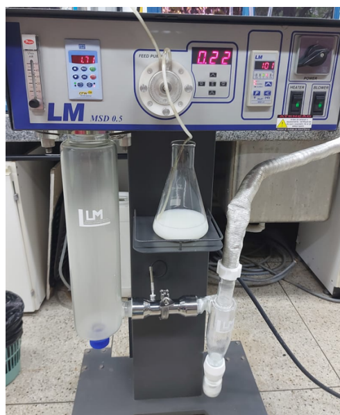
Figura 2 - Spray Dryer utilizado na microencapsulação da bactéria ácido-lática selecionada no presente estudo.
