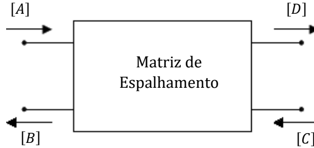
Figura 07 - Representação de Matriz de Espalhamento. Fonte: Adaptada de OLVER, A.D. “Microwave Horns and Feeds”.1994, p.108.
