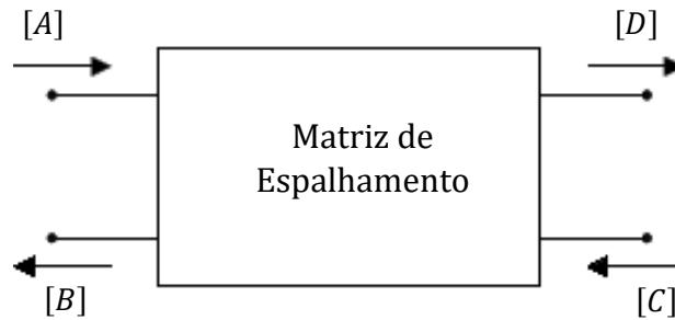
Figura 05 - Representação de Matriz de Espalhamento. Fonte: Adaptada de OLVER, A.D. “Microwave Horns and Feeds”.1994, p.108.
