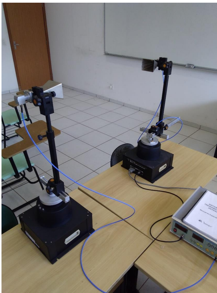
Figura 18 – Medição do diagrama de radiação. Fonte: Autor
