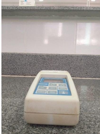
Imagem 4: Equipamento para leitura de turbidez (turbidímetro). Autor: NASCIMENTO, A. P.
