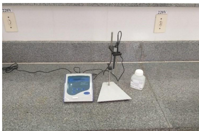
Imagem 1: Equipamento de leitura da condutividade (condutímetro). Autor: NASCIMENTO, A. P.
