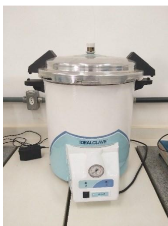
Imagem 5: Autoclave de esterilização de materiais e reagentes. Autor: NASCIMENTO, A. P.
