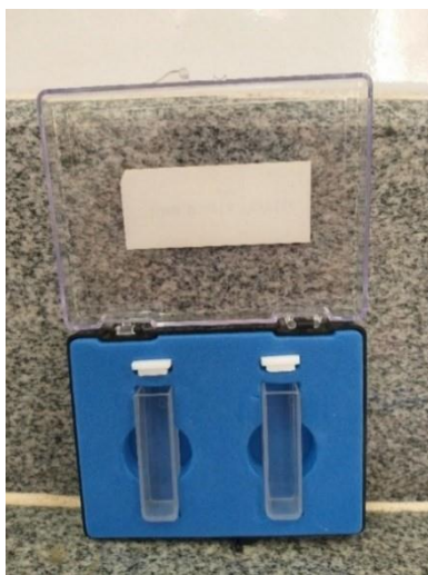
Imagem 2: Cubeta usada para análise de transmitância e cor. Autor: NASCIMENTO, A. P.
