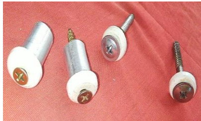
Figura 28 – Aparelhos que fixam os CD's na base
