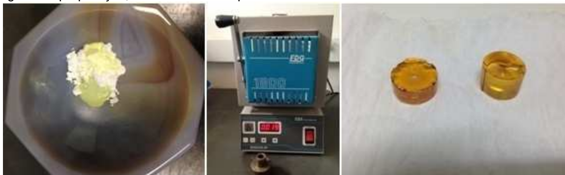
Figura 5 – preparação, fusão e amostra após o recozimento
