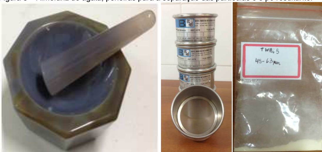
Figura 8 – Almofariz de ágata, peneiras para a separação das partículas e o pó resultante.
