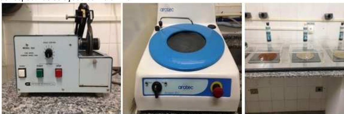
Figura 6 – Máquina de corte, politriz com o uso de lixas d'água e panos para polimento manual com as respectivas soluções com alumina.
