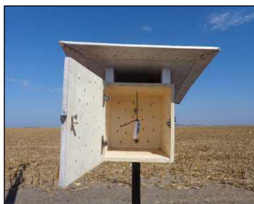
Figura 12- Abrigo de proteção para o datalogger.
