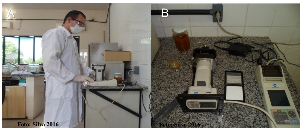
Figura 4.8 Análise de colorimetria: (A) Processo de identificação colorimétrica; (B) Aparelho de colorimetria Minolta CR4000.
