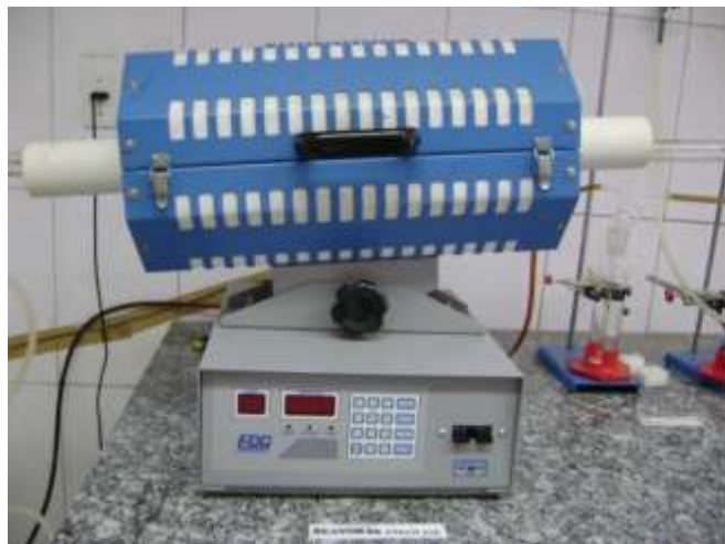
FIGURA 1. Reator de pirólise de bancada
