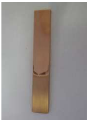
Figura 2 - Lâmina de cobre: análise de corrosão do bio-óleo
